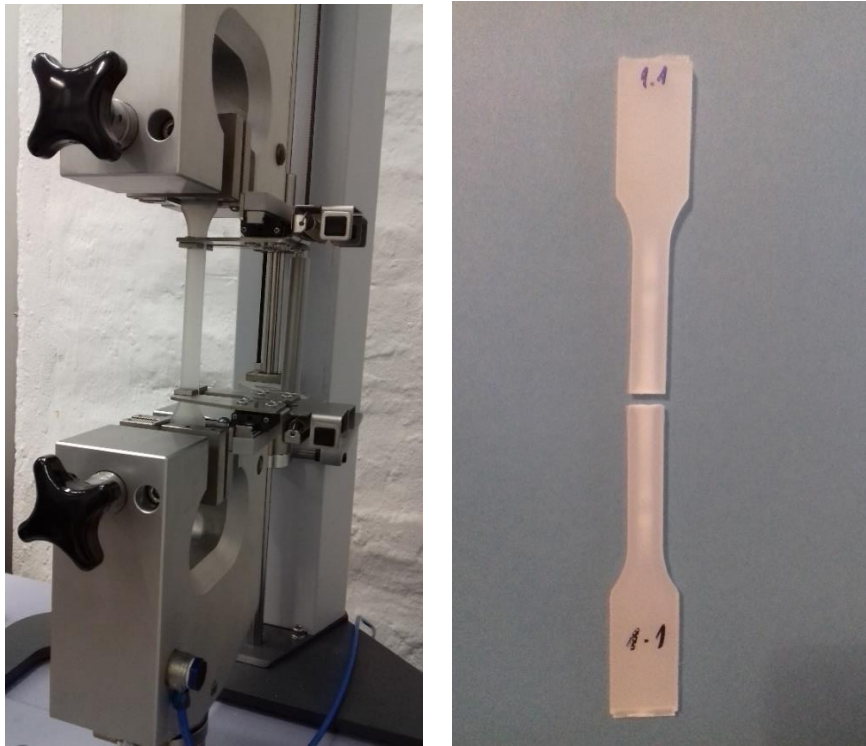
Slika 7.14: a) Kidanje ispitnog tijela b) Lom ispitnog tijela na liniji spoja Vrijednosti rastezne čvrstoće dobivene su dijeljenjem sile potrebne za kidanje ispitnog uzorka s površinom linije spoja.
