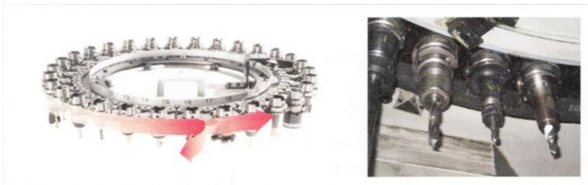
Slika 7. Disk spremište alata: a) skica, b) fotografija detalja [6]
