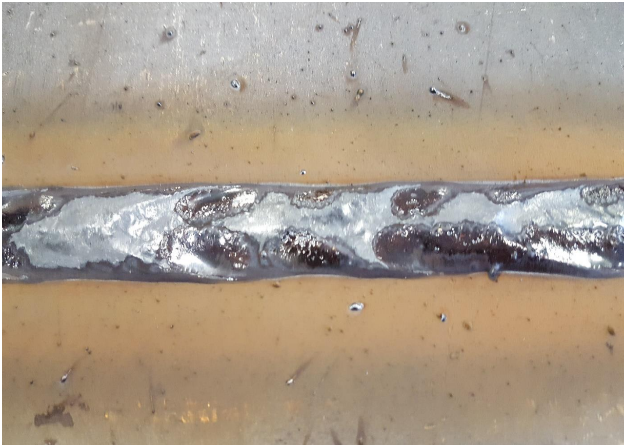
Slika 46. Metalne kapljice uzrokovane rasprskavanjem tijekom zavarivanja
