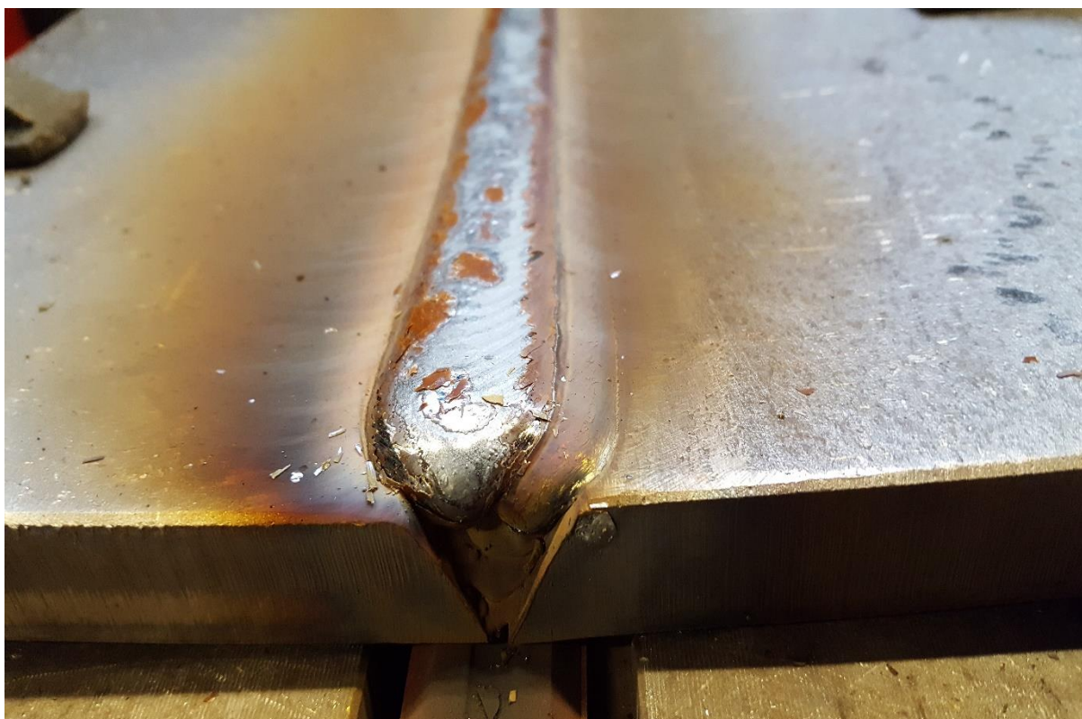
Slika 44. Deformacija nakon završnog prolaza
