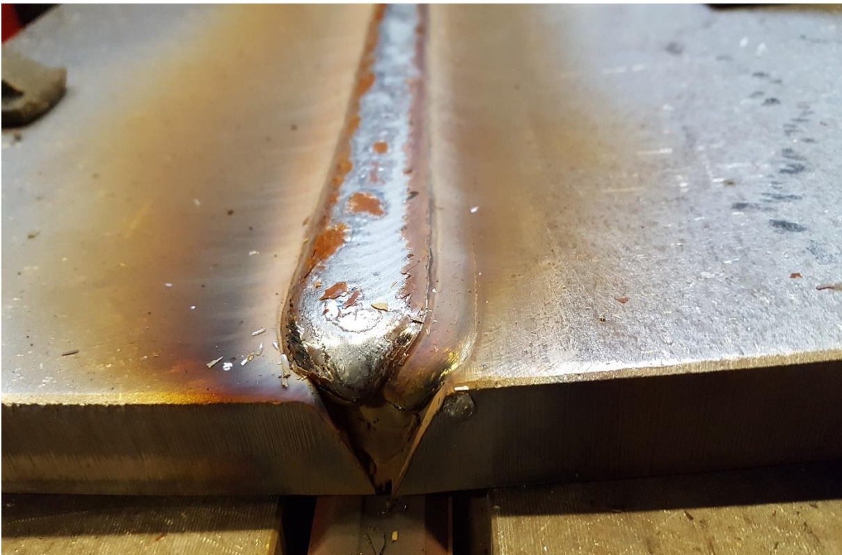
Slika 44. Deformacija nakon završnog prolaza
