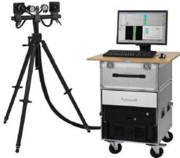
Slika 22 Optički mjerni sustav Aramis [21]
