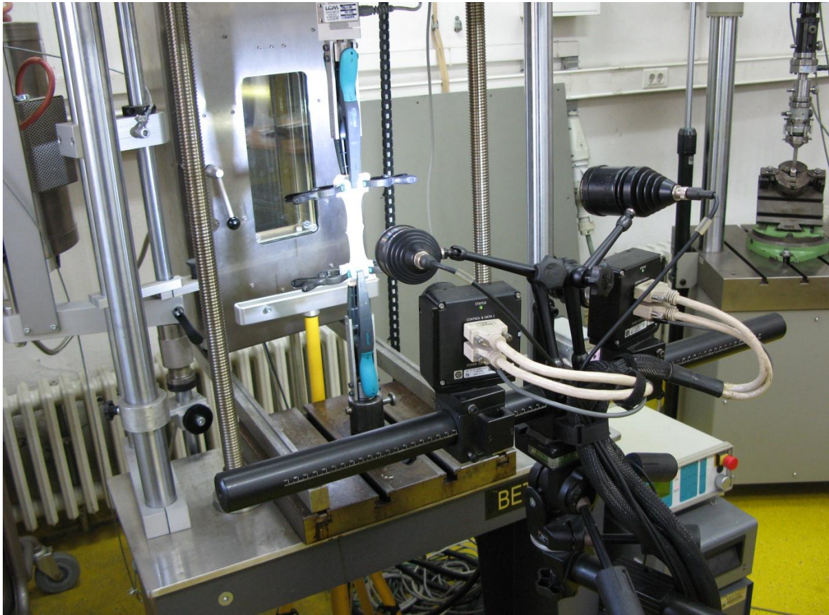
Slika 35 Eksperimentalni postav kod ispitivanja vlačne čvrstoće rane
