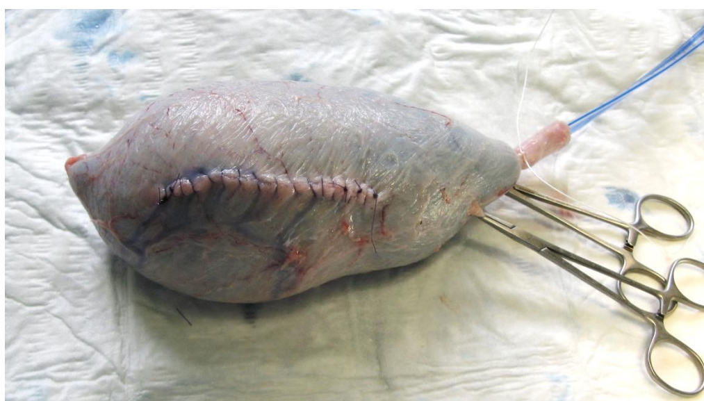
Slika 30 Uzorak u trenutku propuštanja – propuštanje na ubodima
