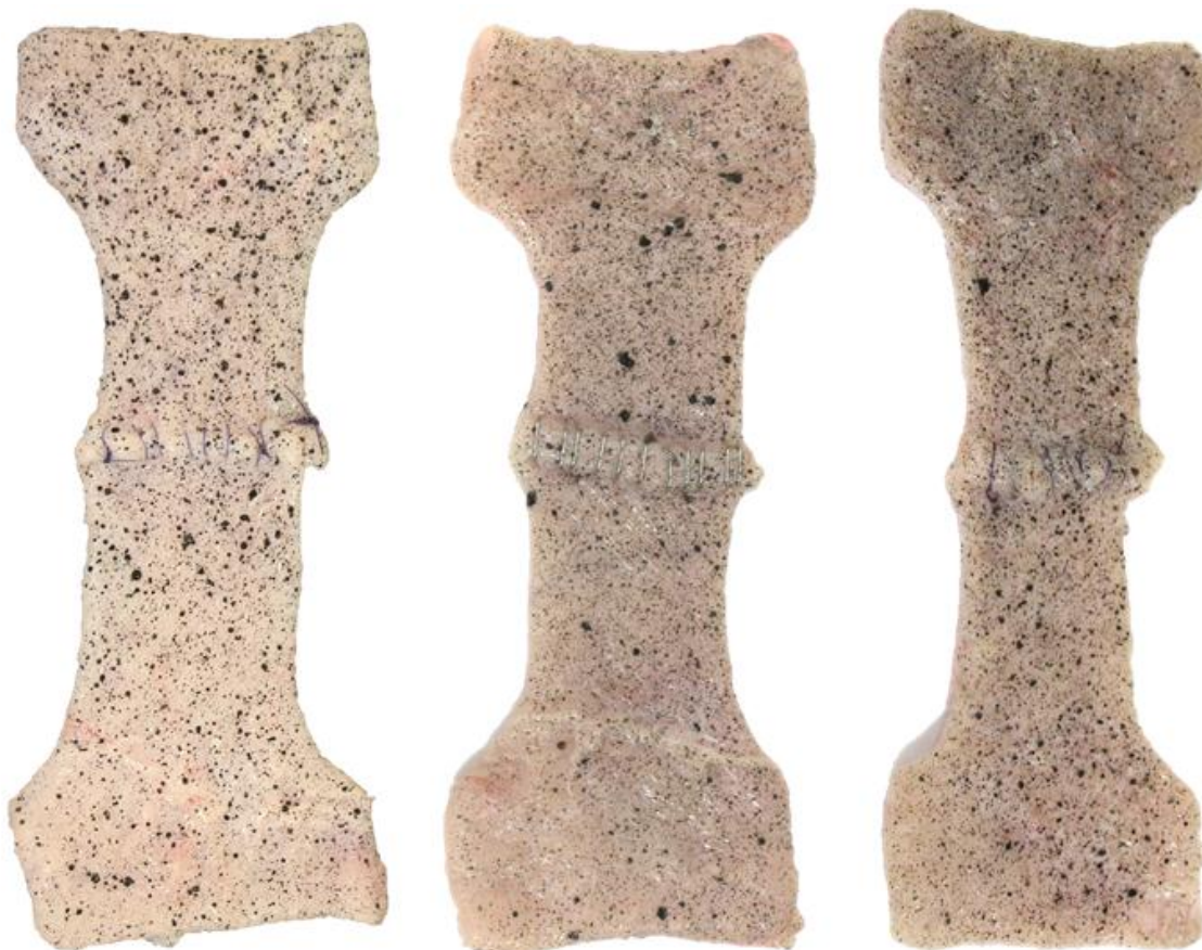
Slika 27 Uzorci pripremljeni za mjerenje optičkim sustavom Aramis
