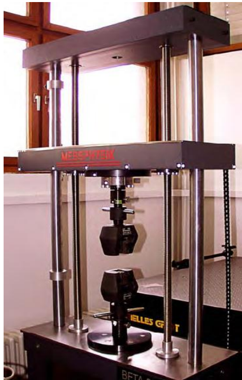
Slika 32 Statička kidalica Messphysik Beta 50-5
