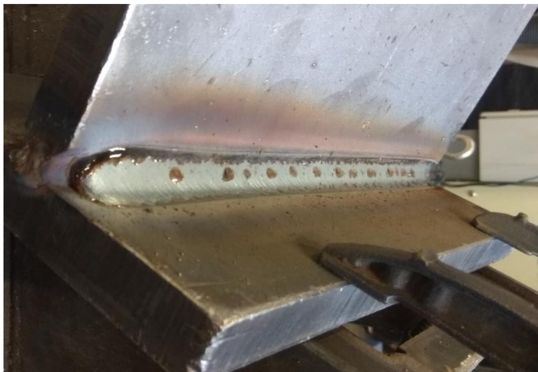
Slika 31. Prikaz zavara dobivenog konvencionalnim MAG postupkom
