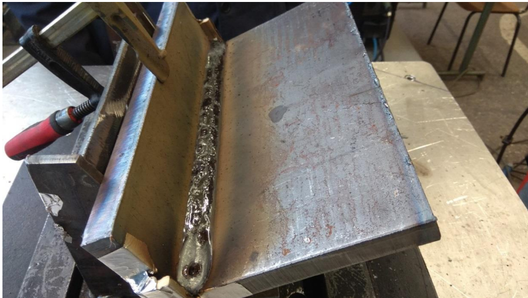
Slika 30. Prikaz zavara napravljen D-Arc postupkom
