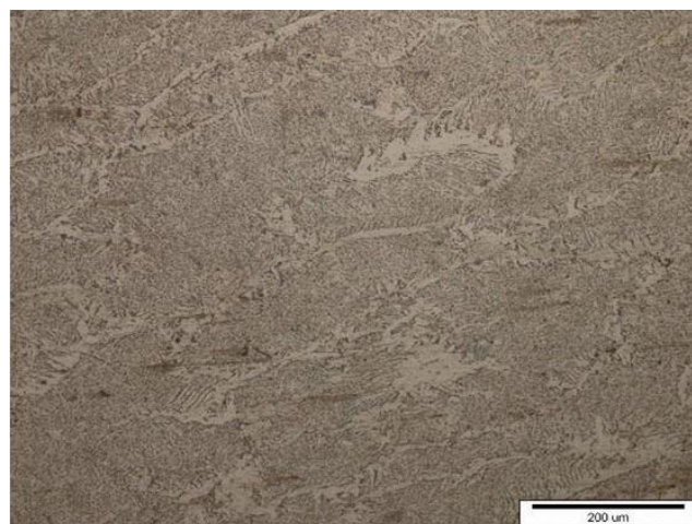
Slika 42. Mikrostruktura ZUT – a [1]
