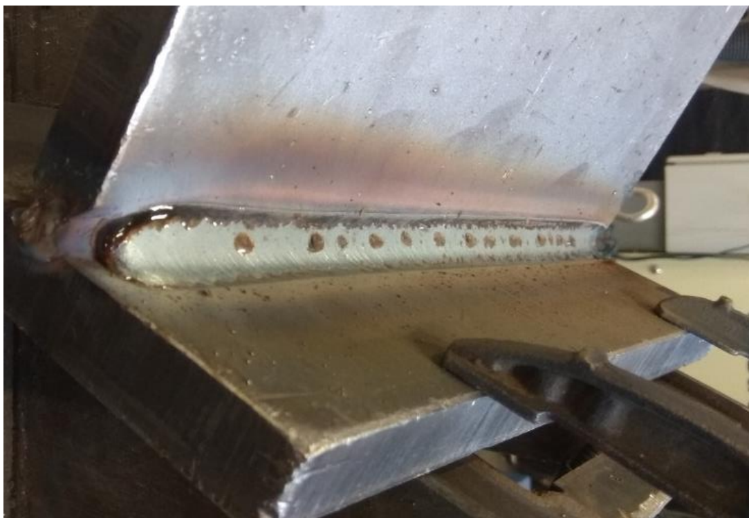
Slika 31. Prikaz zavara dobivenog konvencionalnim MAG postupkom
