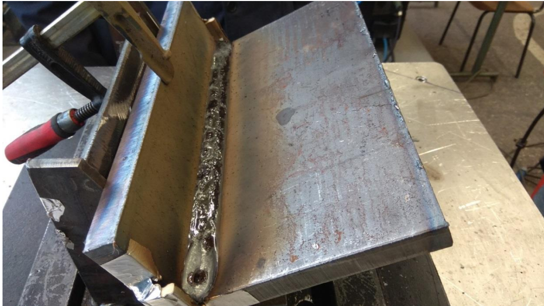
Slika 30. Prikaz zavara napravljen D-Arc postupkom
