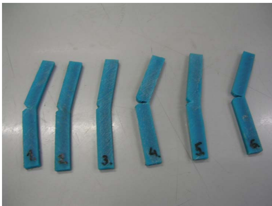
Slika 47. Epruvete tretiranog PA 6/12 G nakon ispitivanja udarnog rada loma
