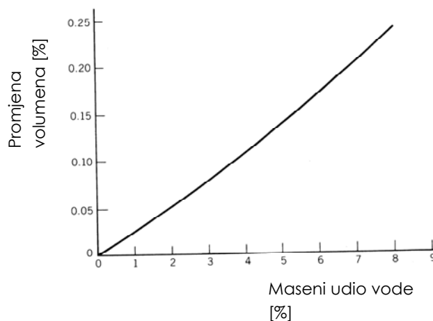
Slika 20. Promjena volumena uslijed apsorpcije vode poliamida 6[6]
