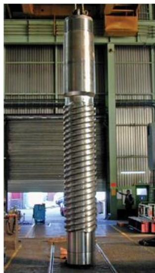
Slika 21. Navojno vreteno frikcijske preše [12]
