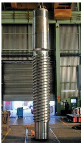
Slika 21. Navojno vreteno frikcijske preše [12]
