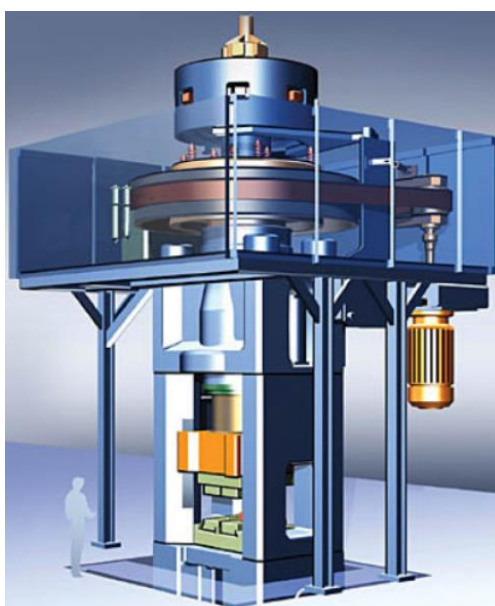
Slika 19. Shema vretenaste električne preše
