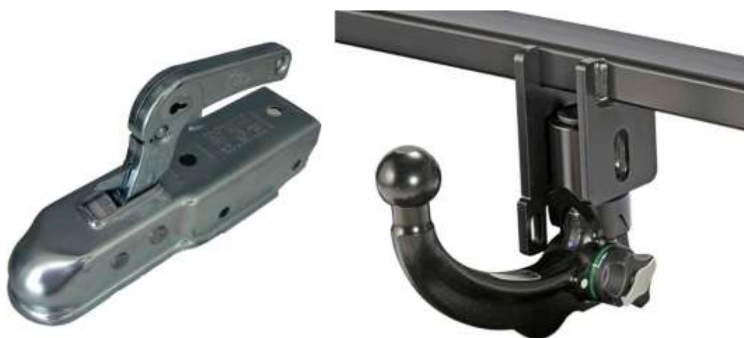
Slika 15. Prijelazna spojka i auto kuka [13]
