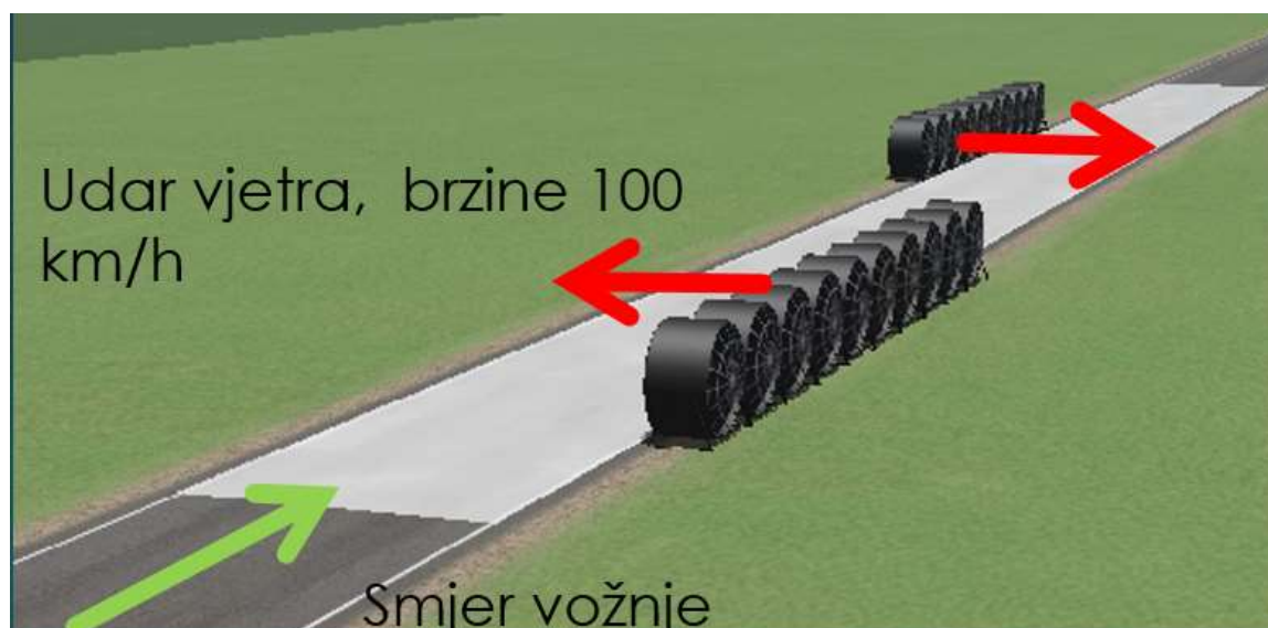
Slika 39. Prikaz ispitne procedure te parametara staze, CarSim
