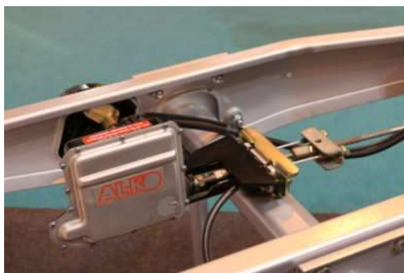
Slika 24. IDC elektro mehanički sustav prikolice [17]
