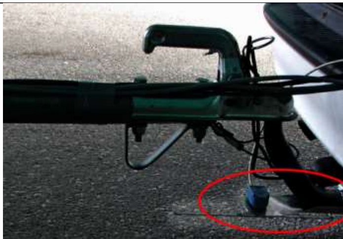
Slika 20. Uređaj za mjerenje kuta između vučnog vozila i prikolice [16]
