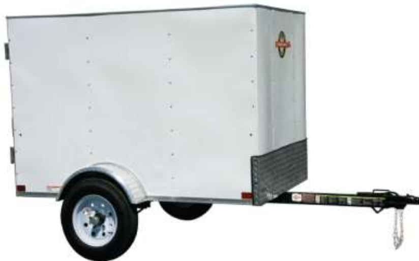
Slika 16. Prikolica jednoosovinska sa zatvorenim tovarnim prostorom [12]
