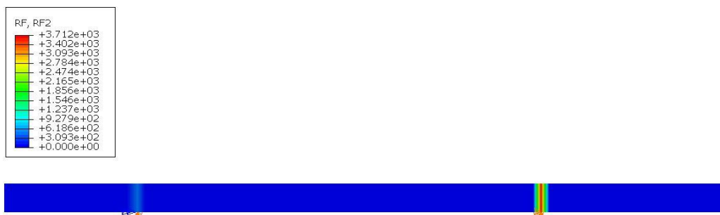
Slika 8.29 Prikaz sila reakcija u osloncima
