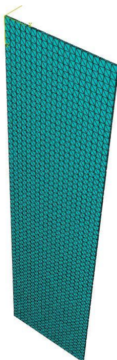
Slika 8.52 Mreža konačnih elemenata na segmentu lima stjenke
