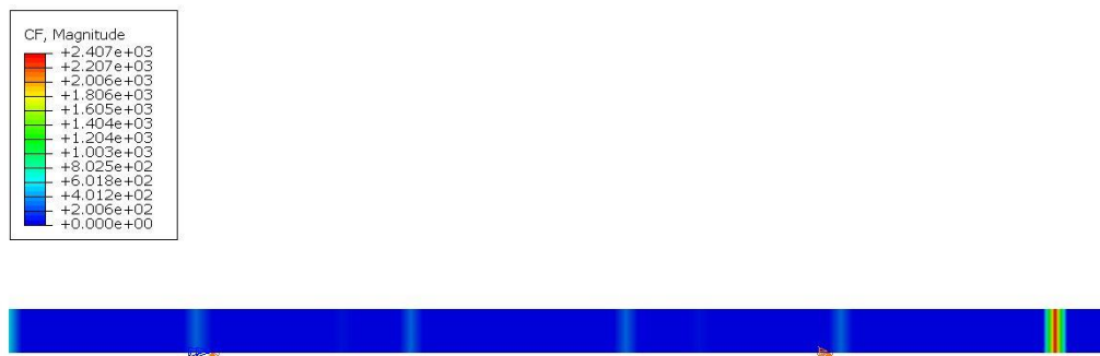
Slika 8.30 Prikaz koncentriranih sila na modelu grede nosača
