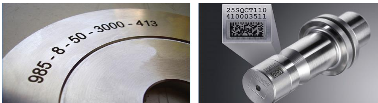
Slika 36. Primjer oznake na planskoj i cilindričnoj površini [7]
