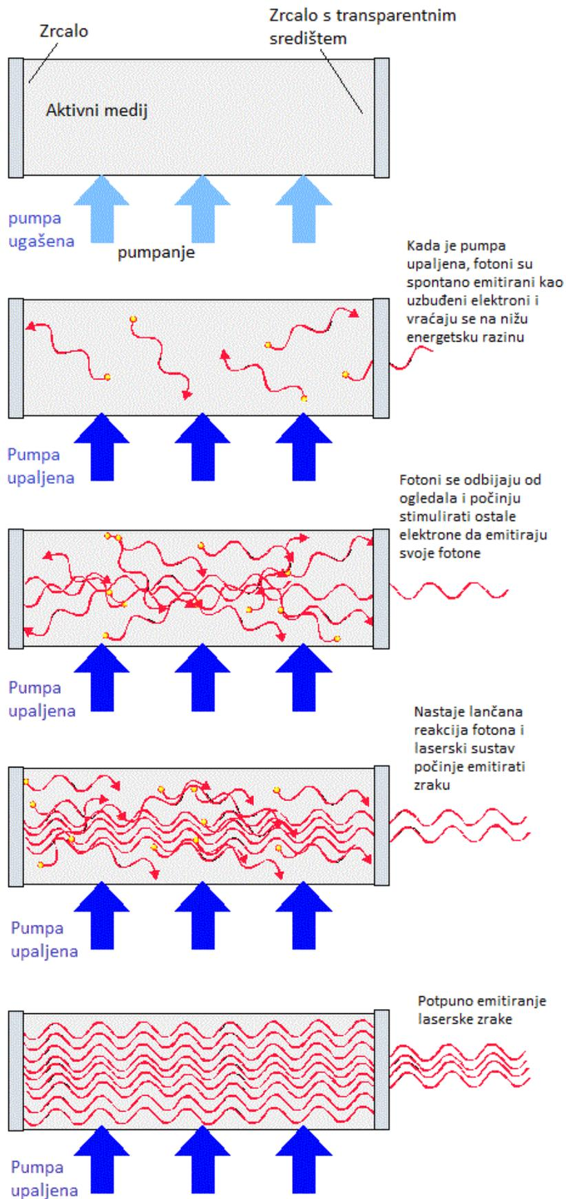
Slika 31. Shematski prikaz nastanka laserske zrake [8]
