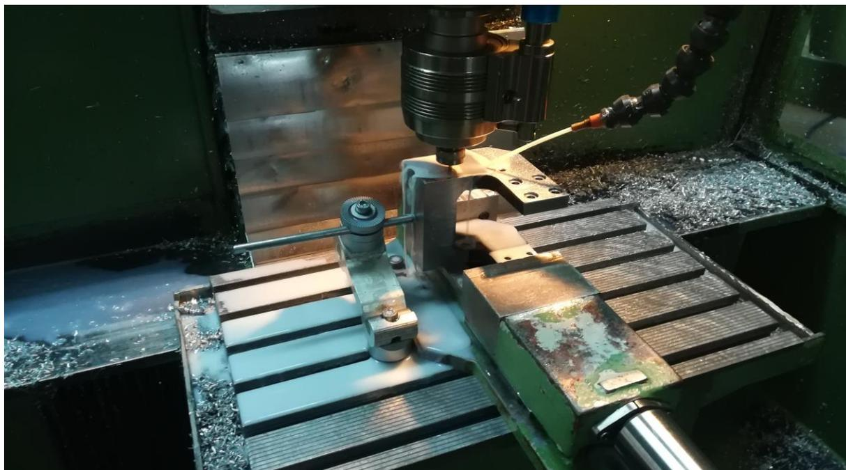
**Slika 28. Graviranje na numerički upravljanoj glodalici**
