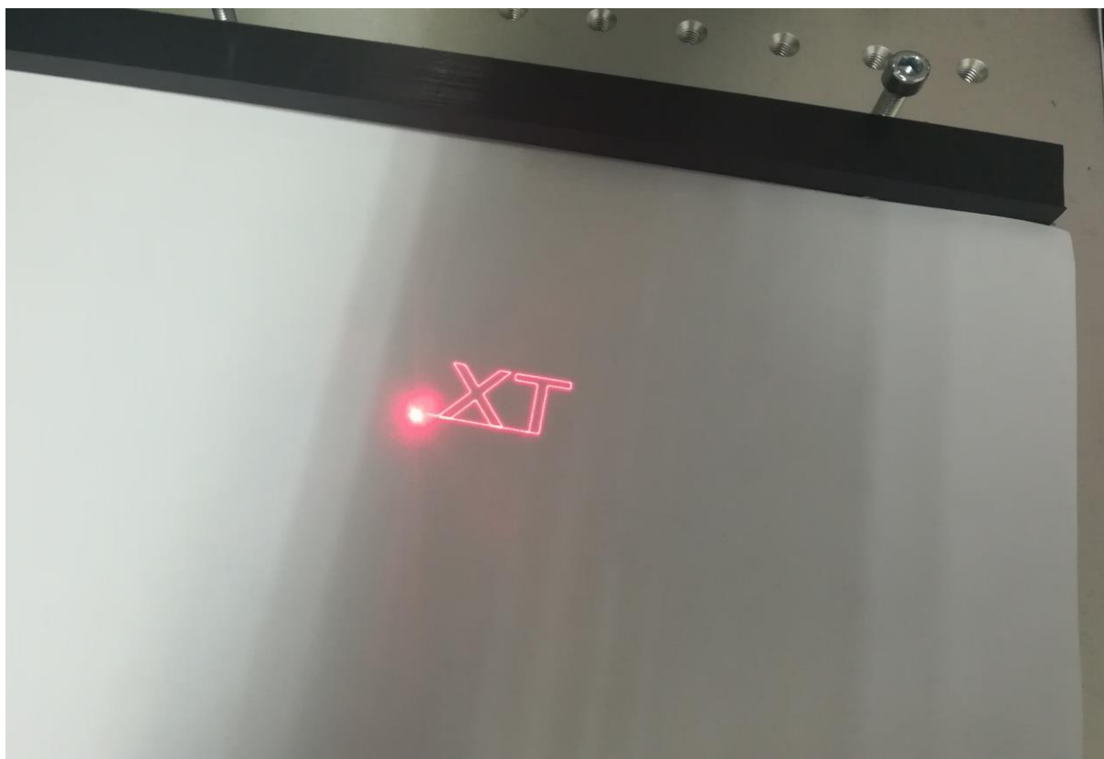
Slika 51. Prikaz oznake prije postupka laserskog označavanja
