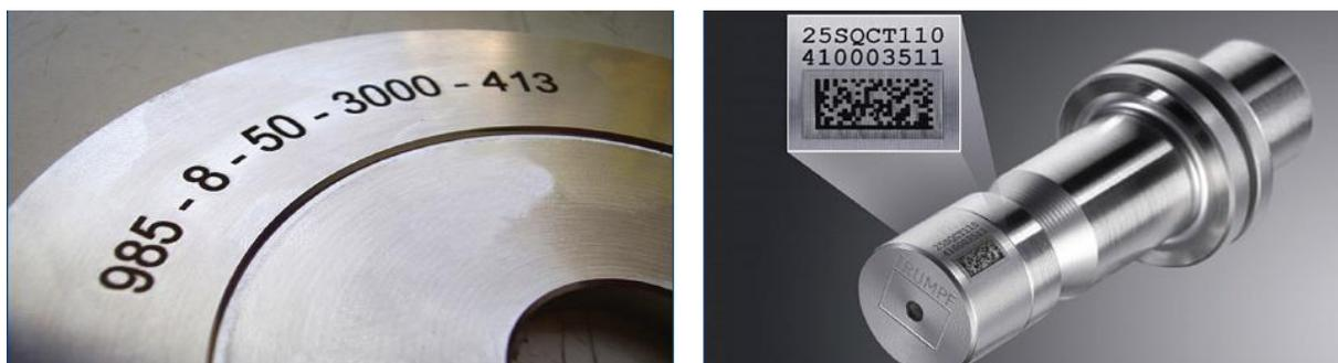
Slika 36. Primjer oznake na planskoj i cilindričnoj površini [7]
