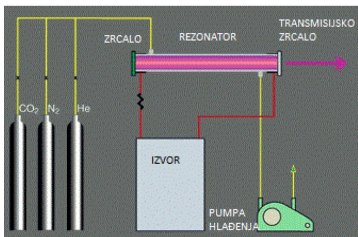
Slika 34. Princip nastanka laserske zrake kod CO<sub>2</sub> lasera [14]
