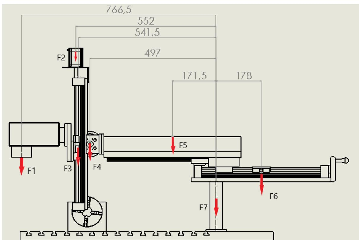
Slika 72. Prikaz djelovanja sila na zavar nosive konstrukcije
