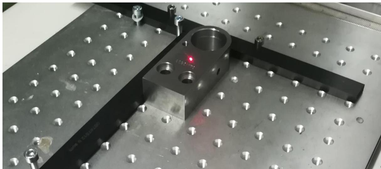
**Slika 88. Pozicioniranje proizvoda kod sustava za lasersko označavanje**
