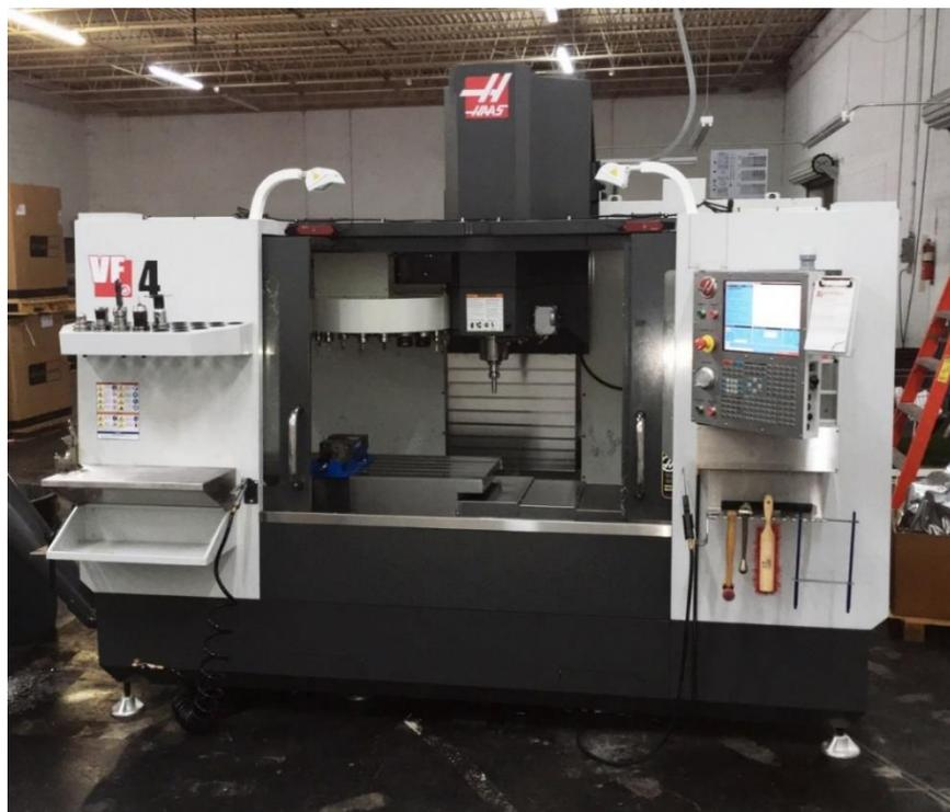
Slika 16. Glodaći obradni centar Haas [5]
