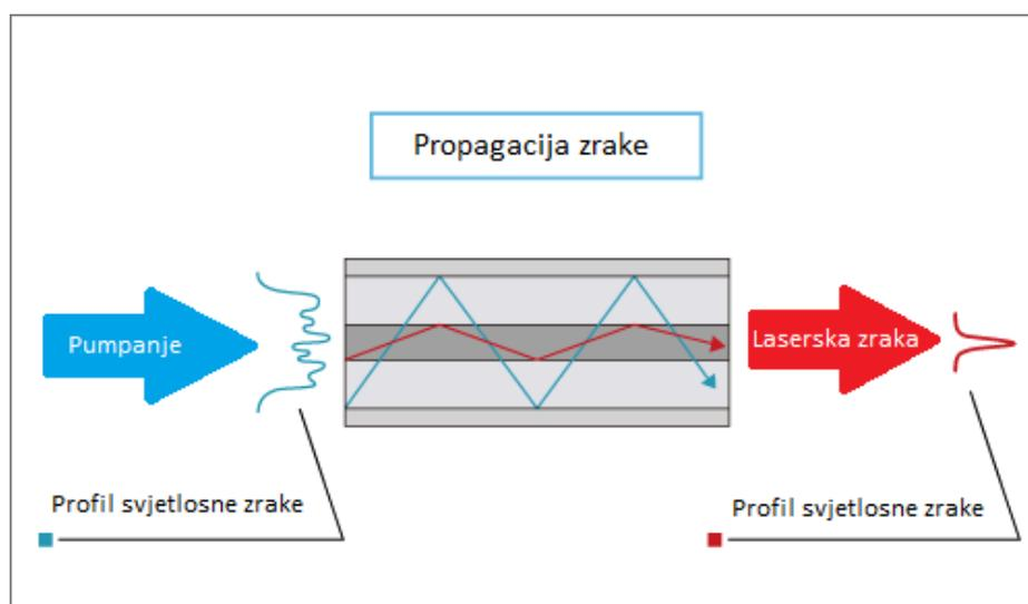
Slika 35. Princip nastanka laserske zrake kod fiber lasera [16]
