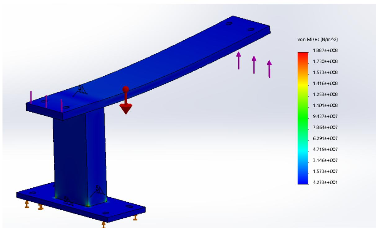
Slika 71. Naprezanja nosive konstrukcije postolja
