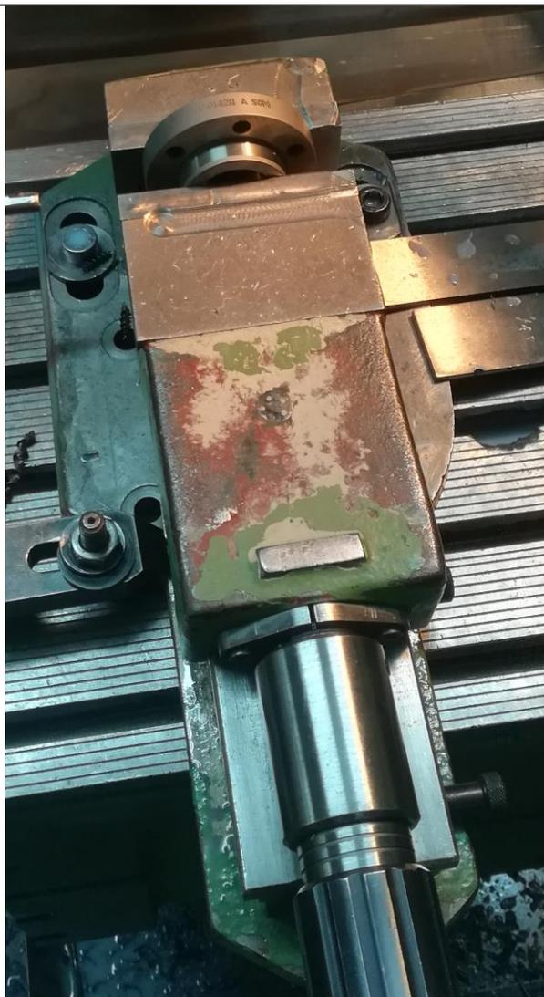
**Slika 87. Stezanje proizvoda na numerički upravljanoj glodalici**
