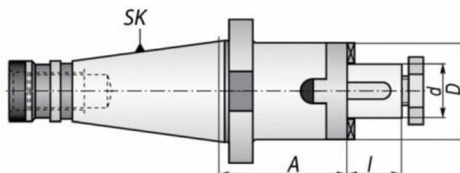
Slika 14. Presjek ISO-SK40 držača alata [23]
