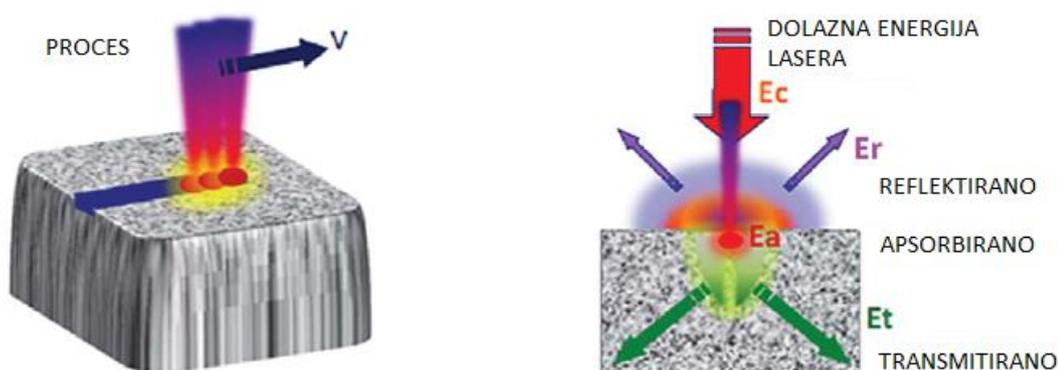
Slika 39. Interakcija laserske zrake s obradkom kod laserskog označavanja [7]
