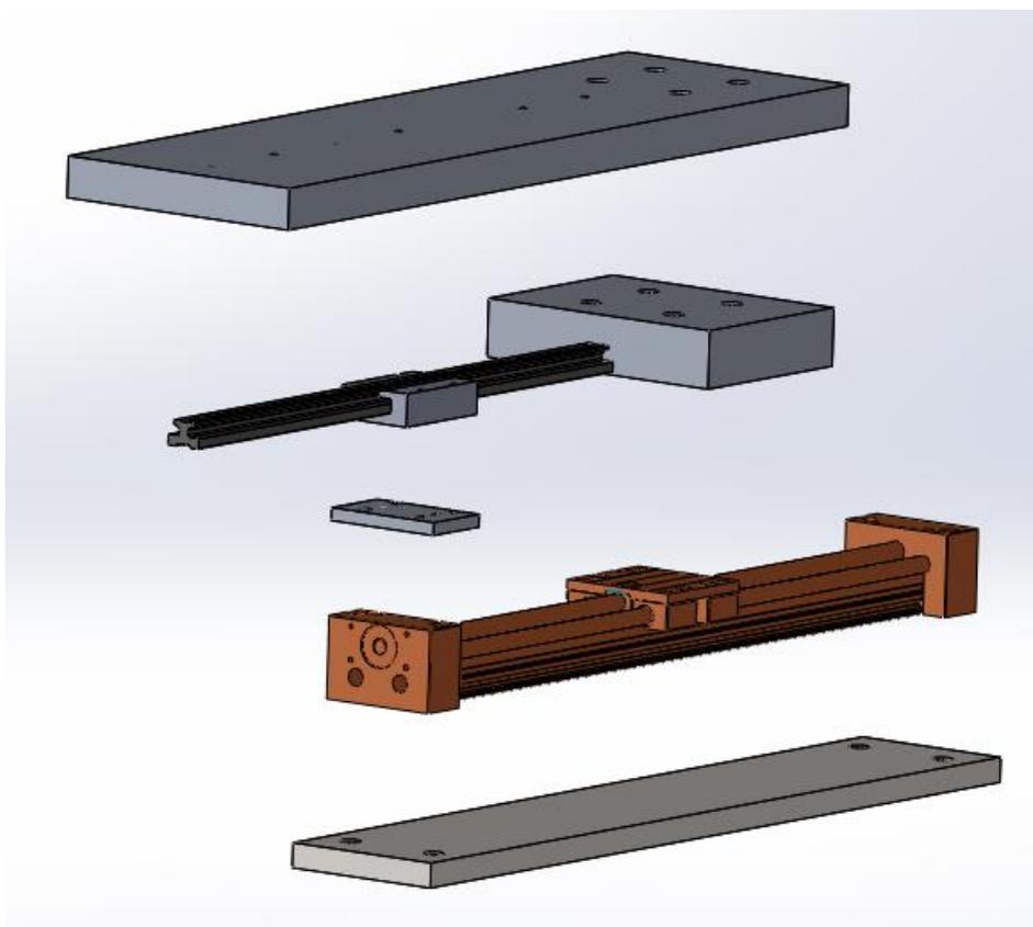
**Slika 66. Raščlanjeni prikaz sustava za vođenje Y osi**
