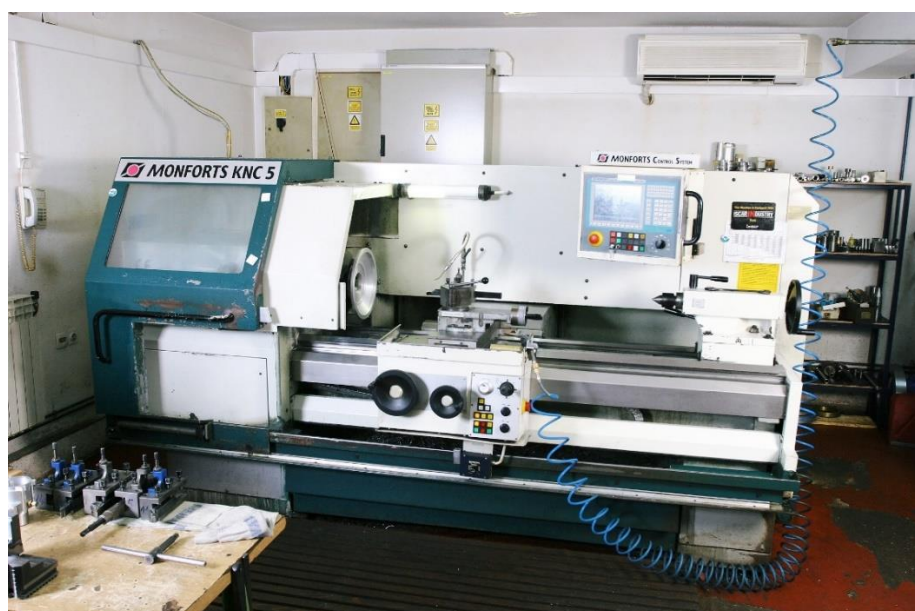
Slika 19. CNC tokarilica Monforts
