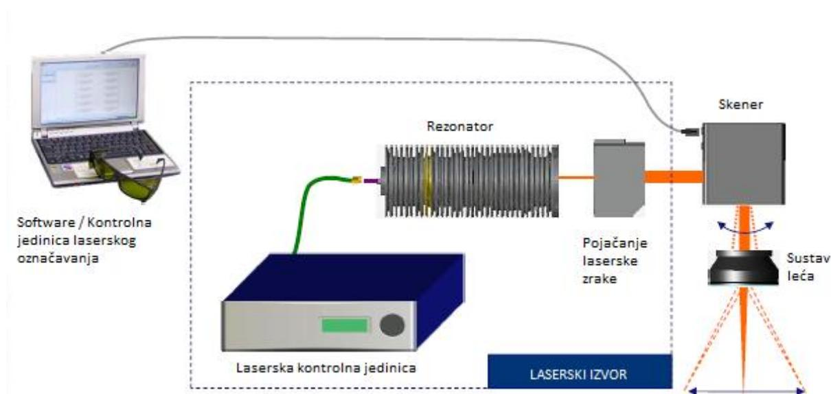
Slika 37. Shema laserskog sustava za označavanje [19]
