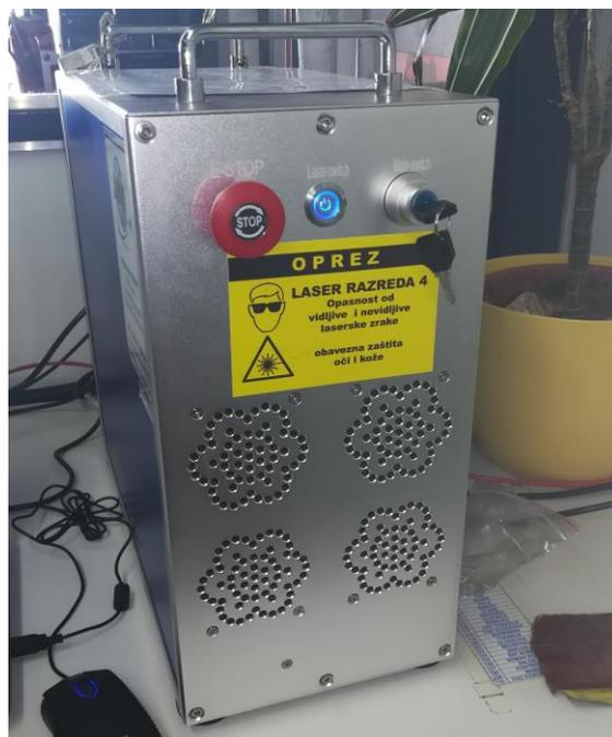
**Slika 52. Izvor napajanja laserskog sustava za označavanje**
