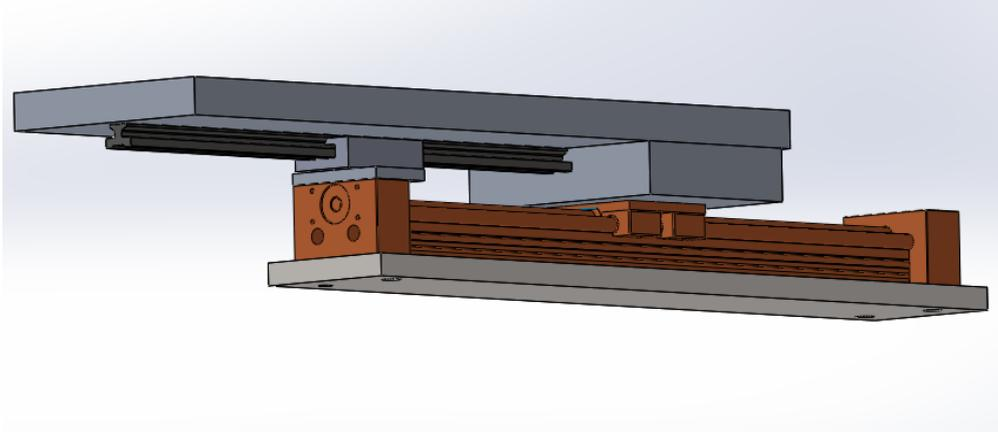
**Slika 65. CAD modela sustava vođenja Y osi**
