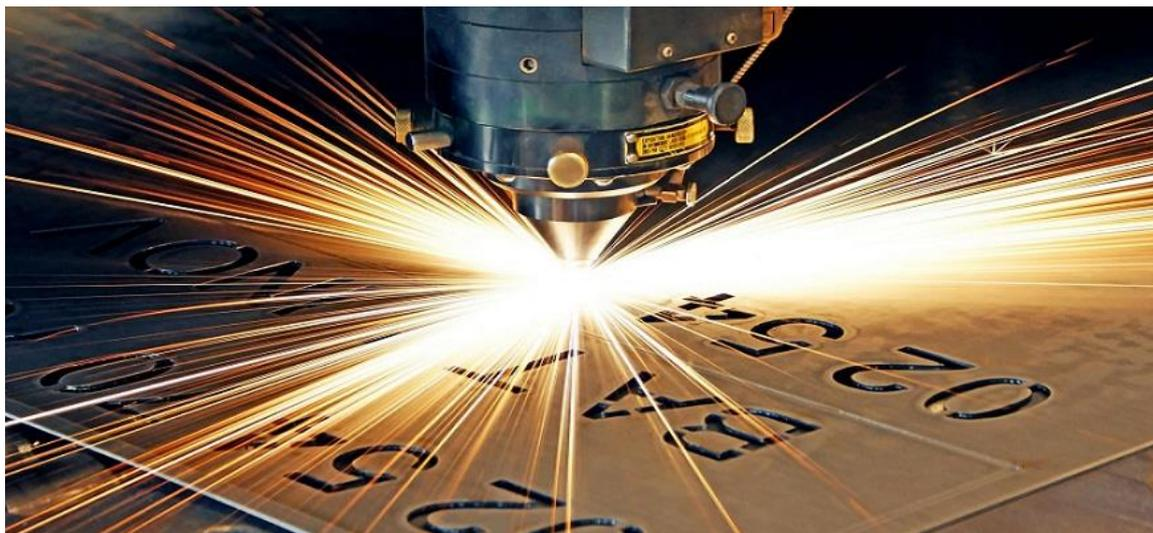
**Slika 1. Lasersko rezanje čelika [2]**
