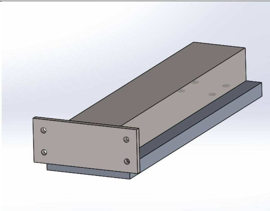
**Slika 57. Prikaz CAD modela dijela nosača križnog suporta**
