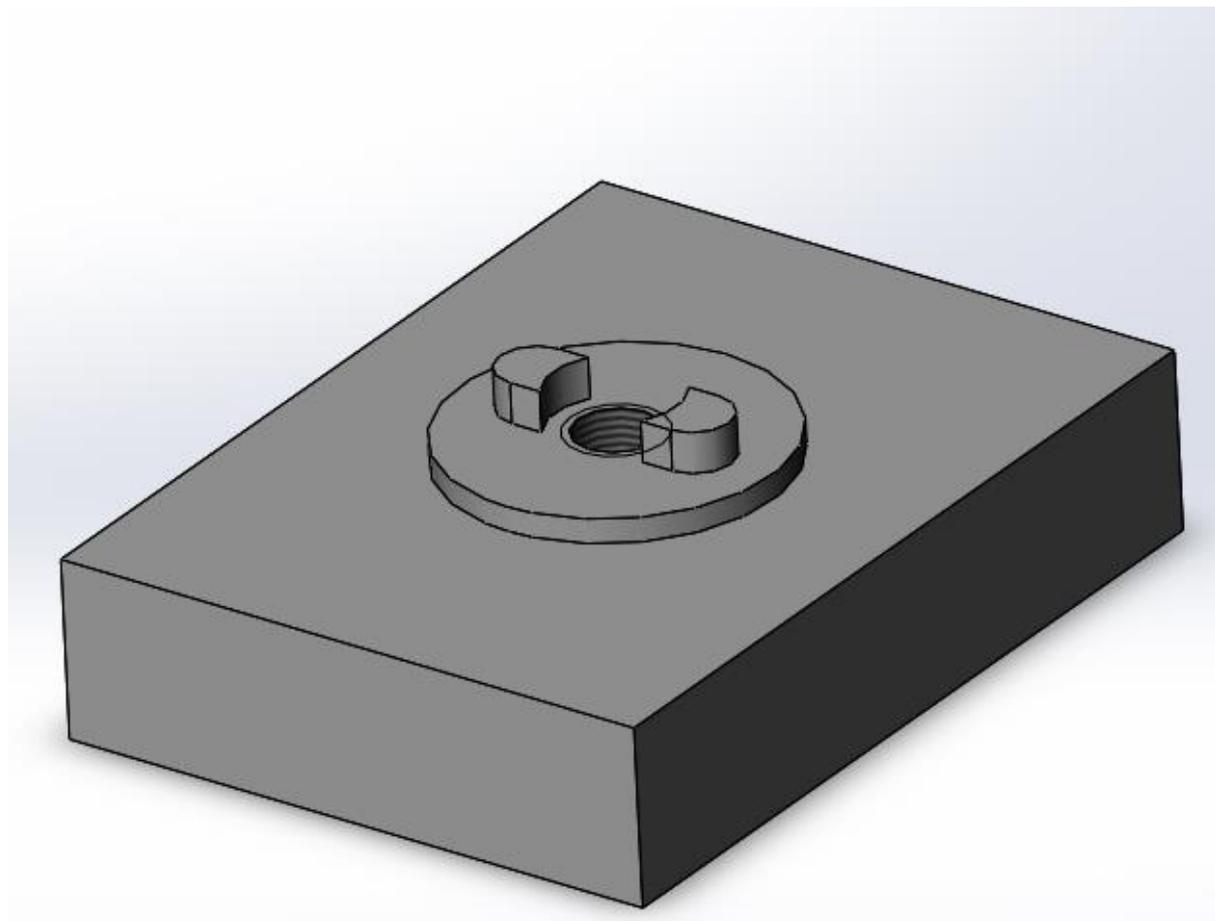
**Slika 22. Prikaz 3D CAD modela stezne naprave za pojednostavljeno stezanje proizvoda**
