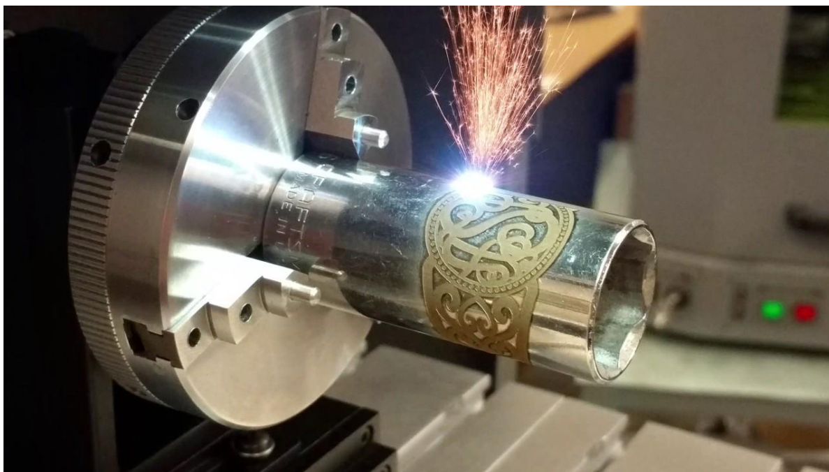
Slika 76. Primjer označavanja obradaka po njihovom obodu [33]
