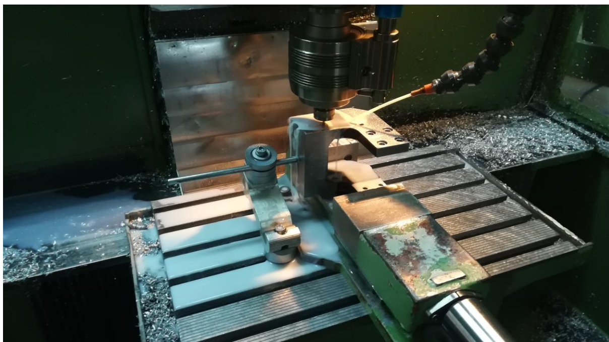
Slika 28. Graviranje na numerički upravljanoj glodalici
