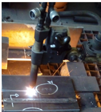
Slika 21. Rezanje ploča plinskim plamenom
