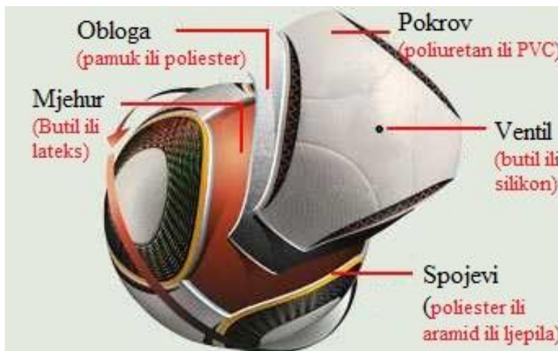
Slika 24. Materijali za dijelove lopte [9]
