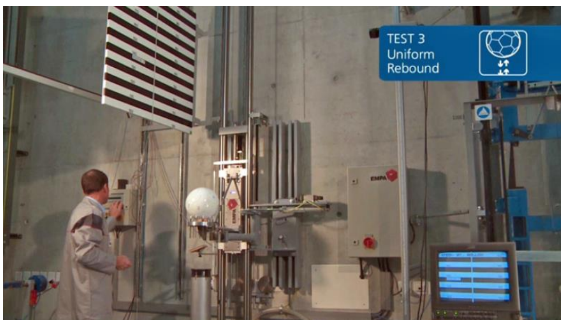
Slika 27. Mjerenje odskakanja lopte [4]
