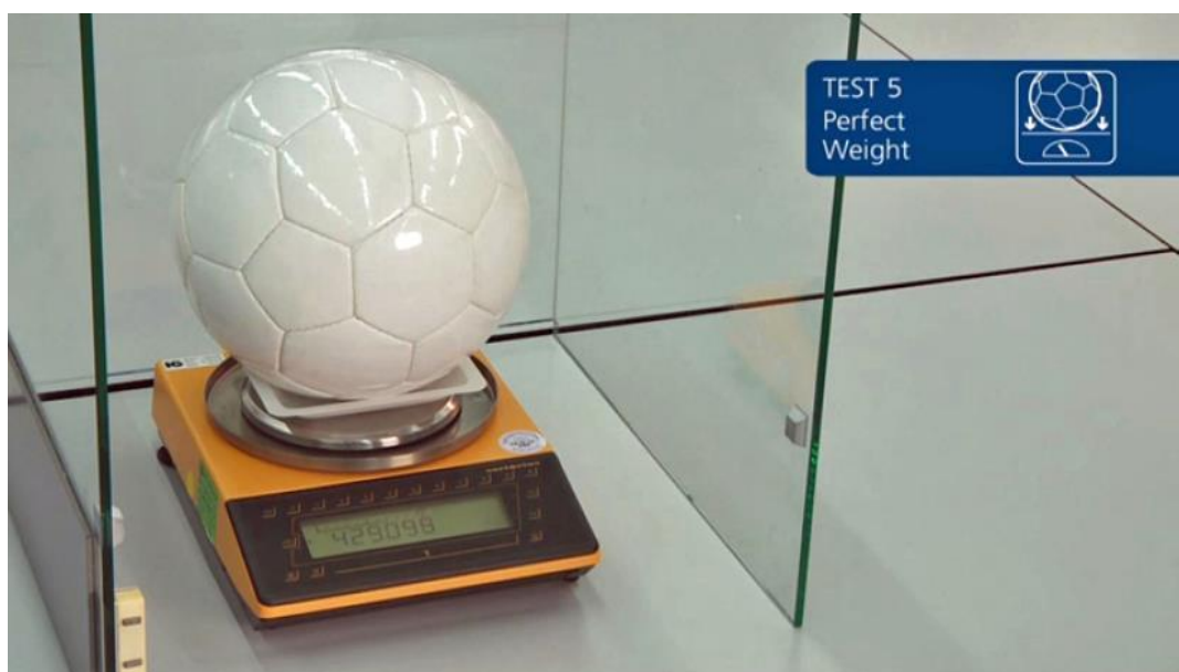
Slika 30. Mjerenje mase lopte [4]
