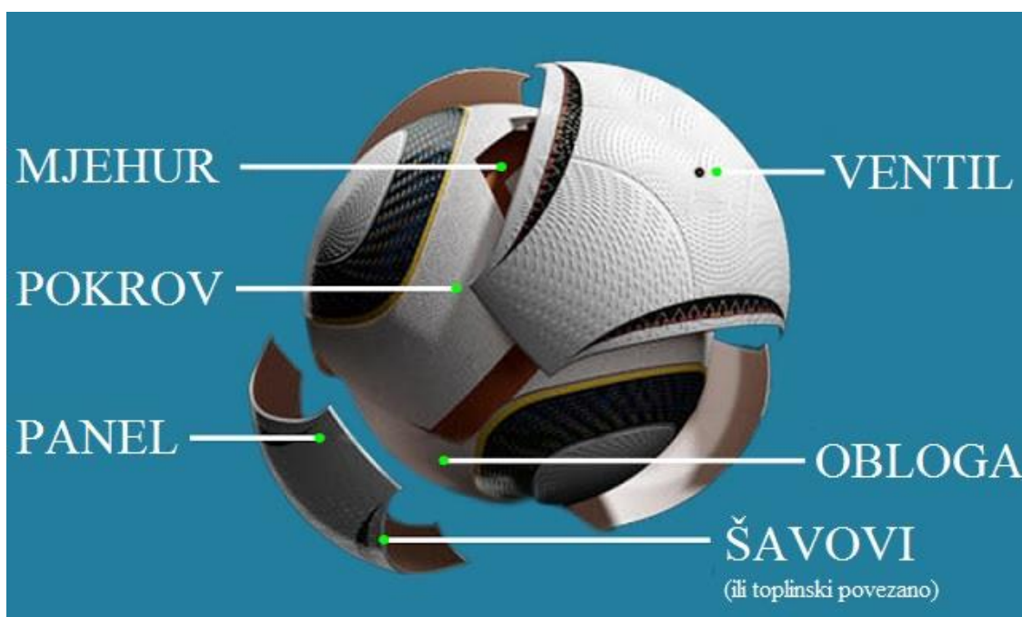
Slika 23. Konstrukcija nogometne lopte [8]
