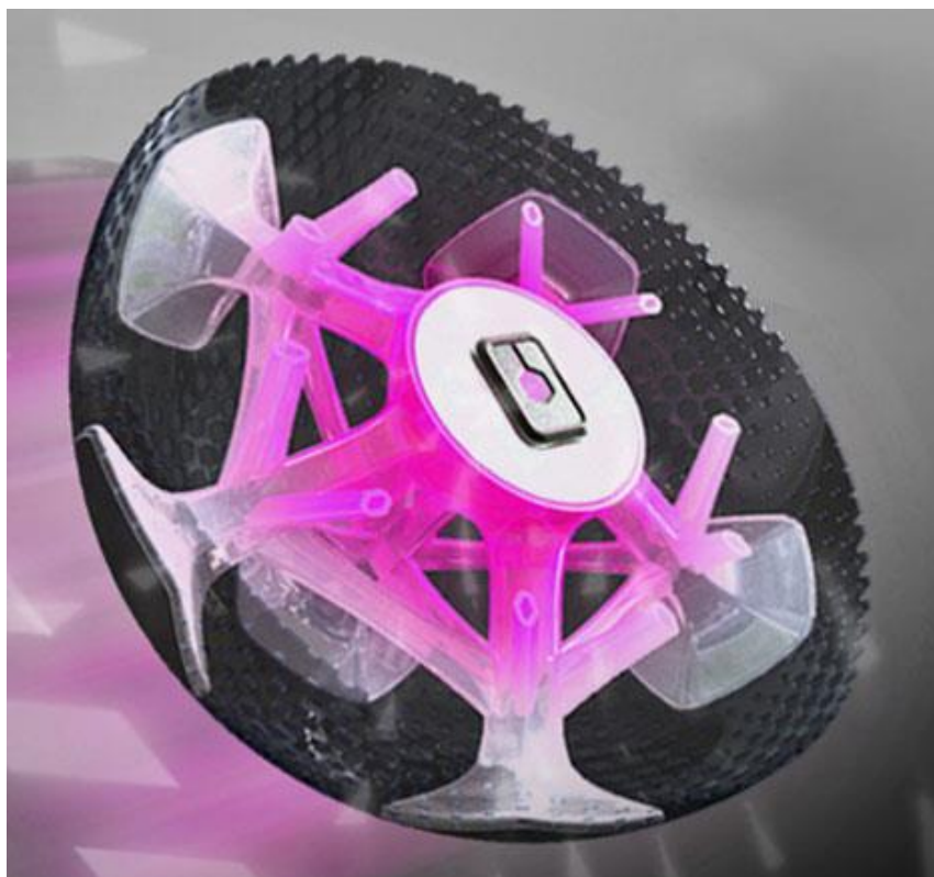
Slika 33. Presjek nogometne lopte s čipom [12]
