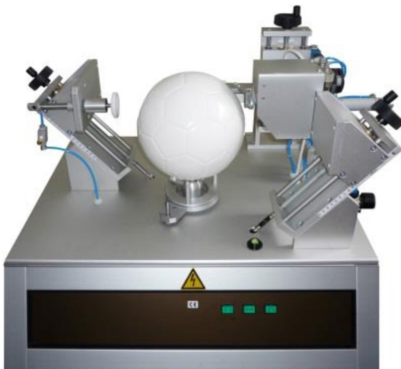
Slika 25. Uređaj za mjerenje radijusa [4]
