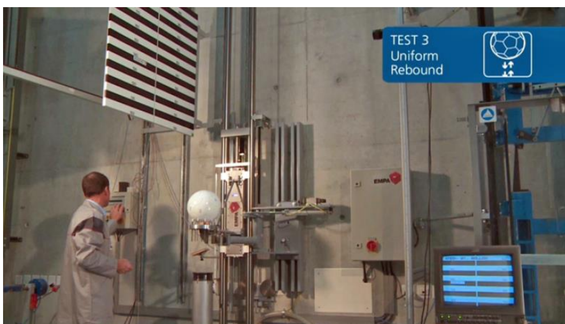
Slika 27. Mjerenje odskakanja lopte [4]
