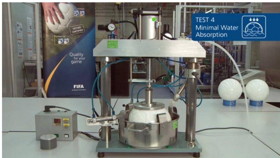
Slika 29. Mjerenje apsorpcije vode [4]
