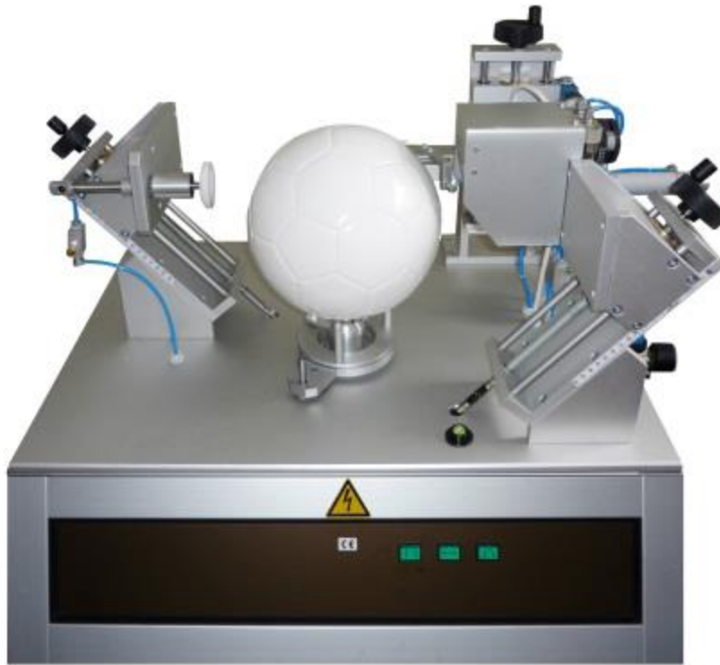
Slika 25. Uređaj za mjerenje radijusa [4]
