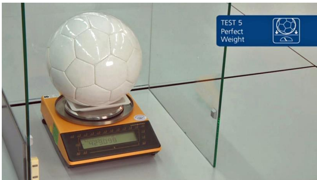
Slika 30. Mjerenje mase lopte [4]
