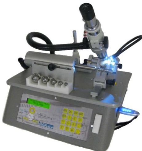
Slika 31 Uređaj za ispitivanje debljine prevlake [26]
