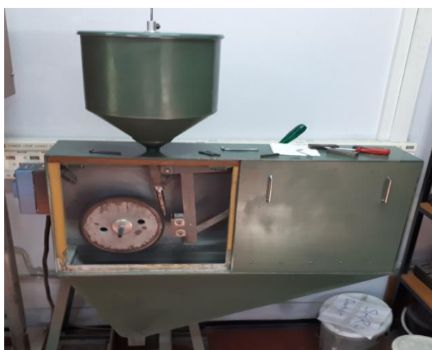
Slika 25 uređaj za ispitivanje otpornosti na abrazijsko trošenje
