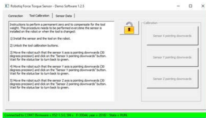
Slika 3.11. Kalibracija senzora putem eksternog računala (laptopa)
