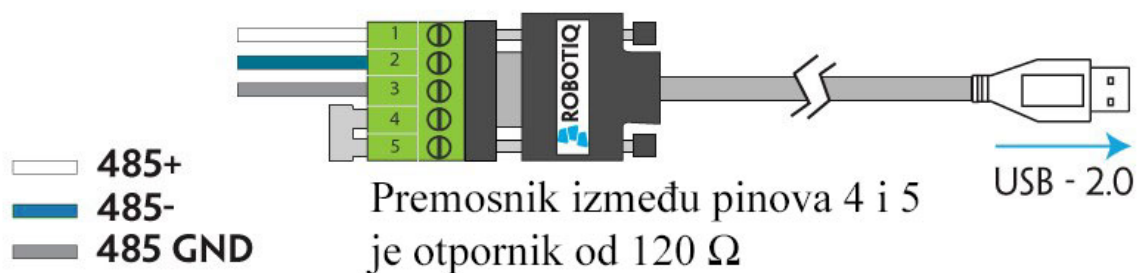
Slika 3.7. Dijagram ožičenja senzora
