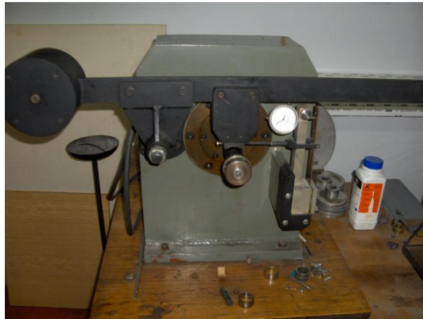
Slika 31. Uređaj za ispitivanje otpornosti na adhezijsko trošenje
