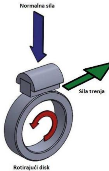
Slika 15. Shematski prikaz ispitivanja metodom „Block on Ring“ [45]
