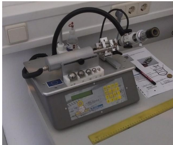
Slika 29. Uređaj za određivanje debljine prevlake (kalotester)
