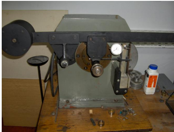
Slika 31. Uređaj za ispitivanje otpornosti na adhezijsko trošenje
