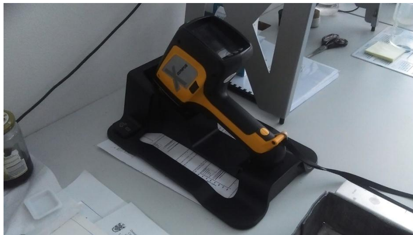
Slika 22. Uređaj Olympus X za određivanje kemijskog sastava
