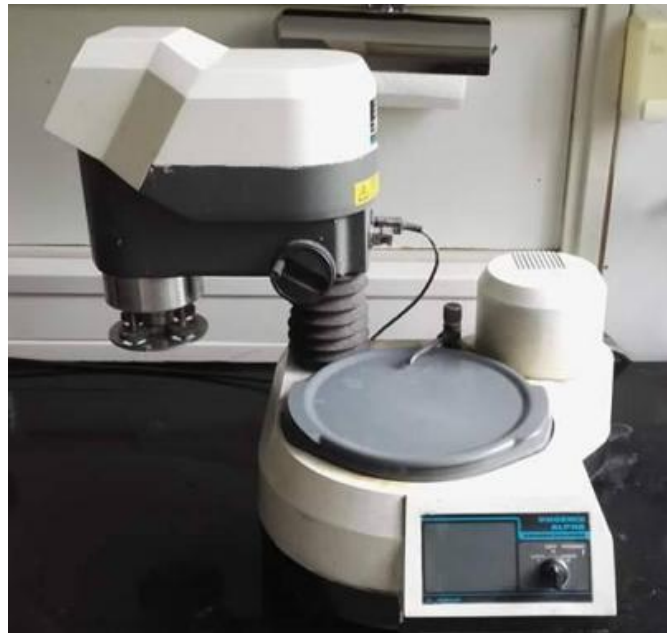
Slika 24. Buehler Phoenix Alpha uređaj za pripremu uzoraka
