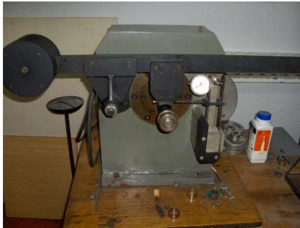
Slika 31. Uređaj za ispitivanje otpornosti na adhezijsko trošenje
