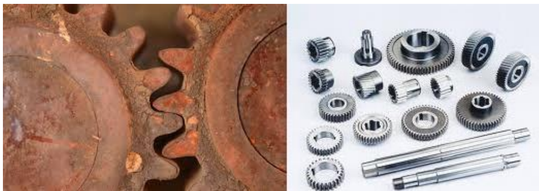
Slika 1. Korodirani zupčanci (lijevo) i zupčanici od nehrđajućeg čelika (desno)
