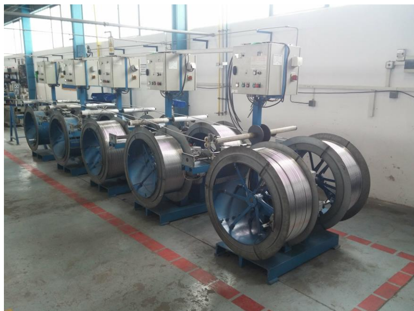
Slika 24. Sustav za namatanje gotovih cijevi
