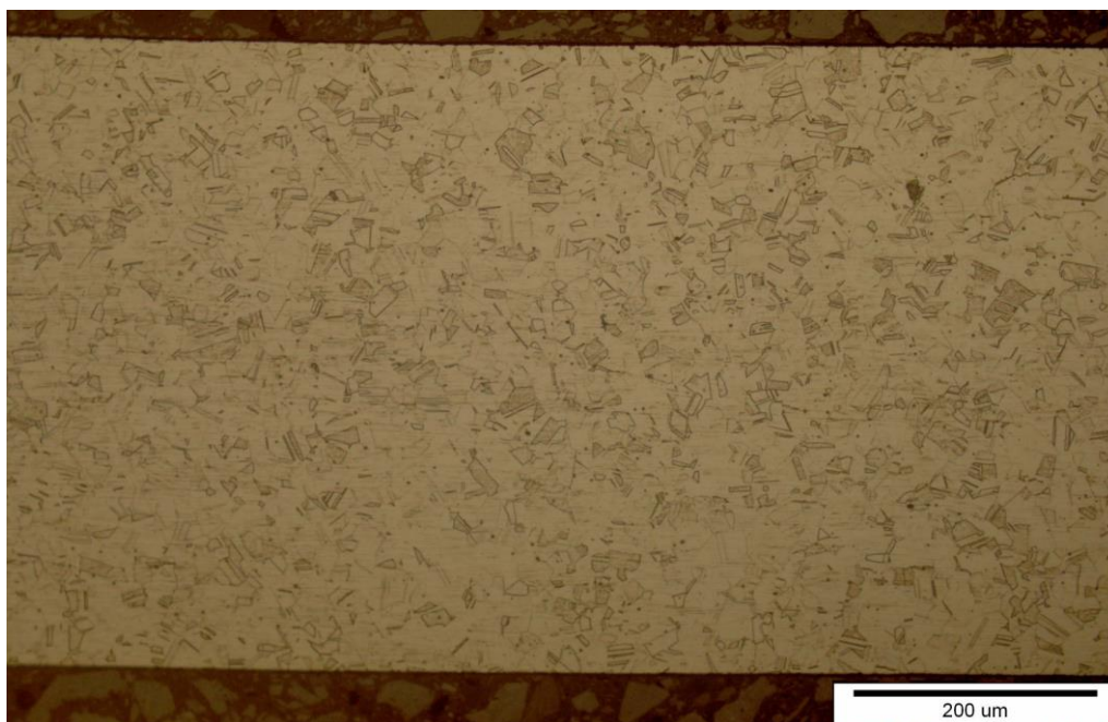
Slika 33. Mikrostruktura poprečnog presjeka lima u nagriženom stanju
