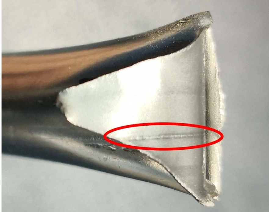
Slika 17. Zavar s unutarnje strane cijevi
