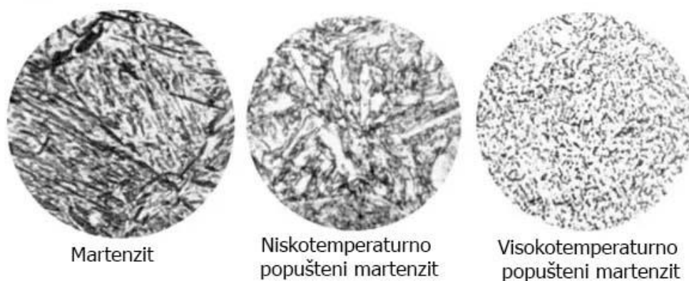
Slika 7. Martenzit pri različitim temperaturama popuštanja [7]
