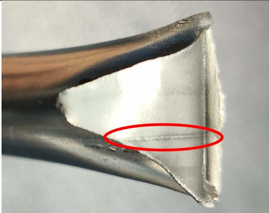
Slika 17. Zavar s unutarnje strane cijevi
