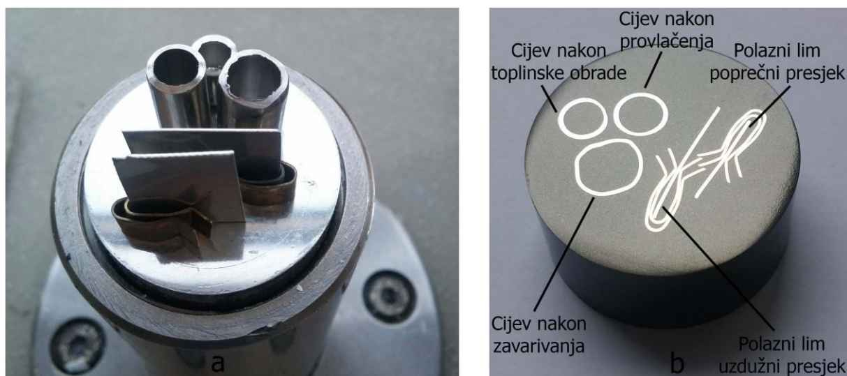
Slika 26. Uzorci postavljeni na platformu (a) i uzorci zaliveni u masu (b)
