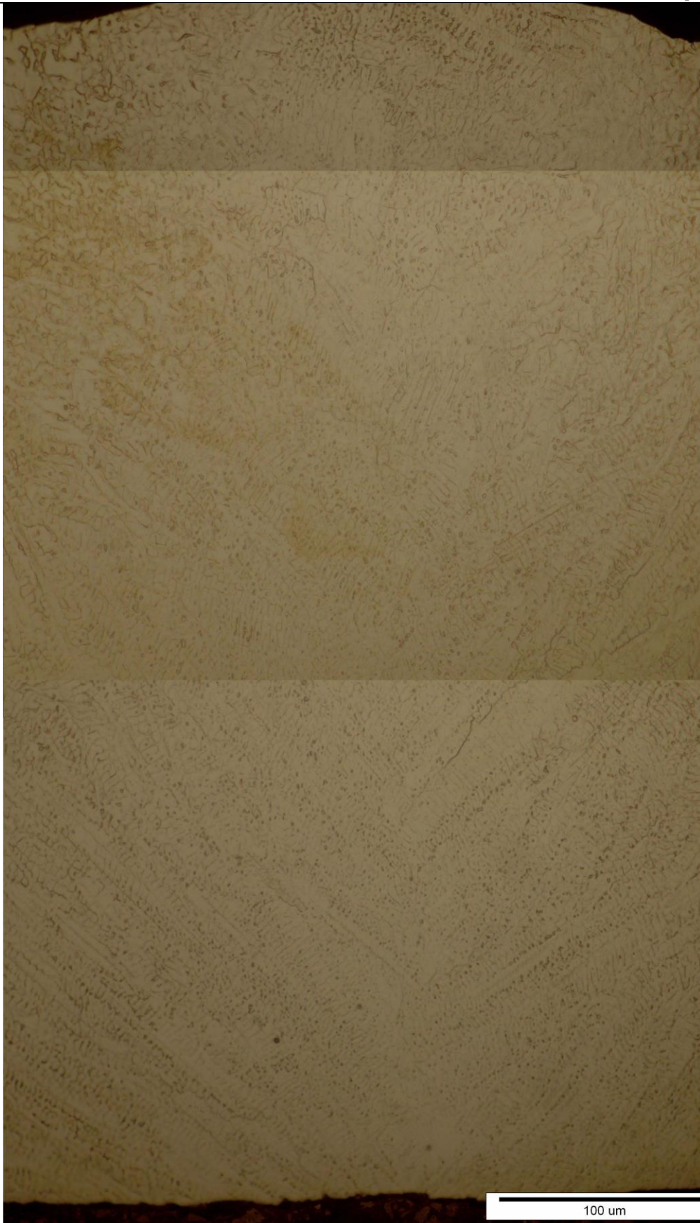
Slika 41. Mikrostruktura metala zavara u nagiženom stanju
