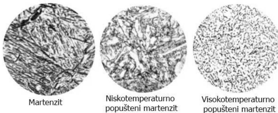
Slika 7. Martenzit pri različitim temperaturama popuštanja [7]
