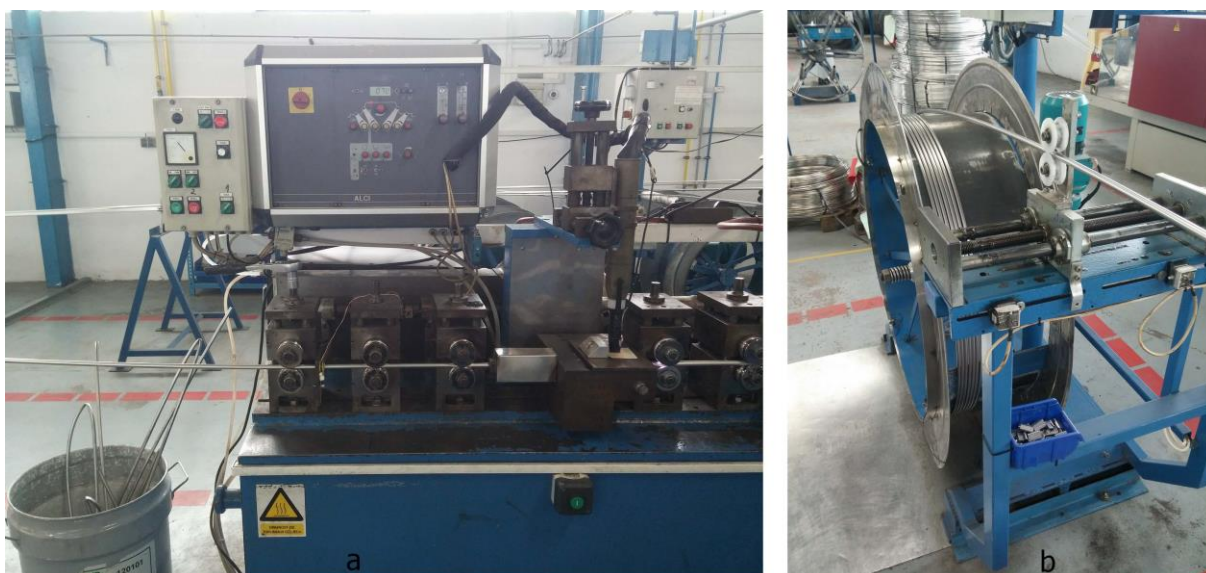
Slika 19. Izlazak cijevi iz komore za zavarivanje (a) i namatanje cijevi na kolut (b)
