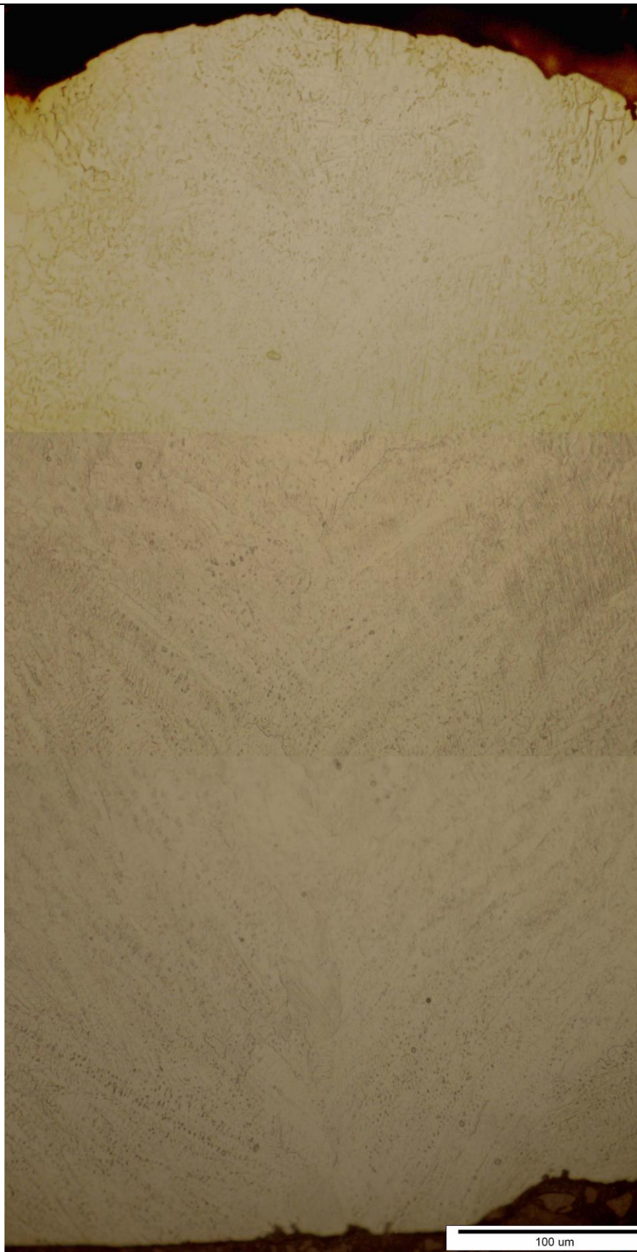
Slika 47. Mikrostruktura metala zavara nakon provlačenja
