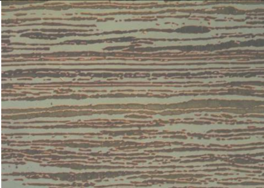
Slika 10. Mikrostruktura dupleks čelika [3]
