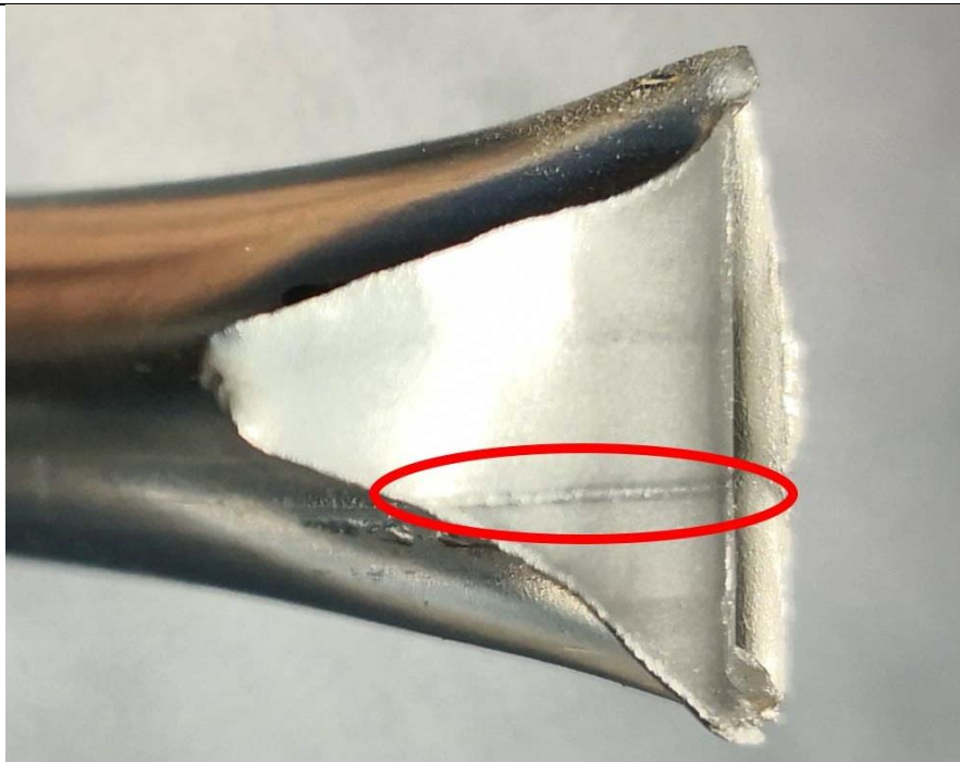
Slika 17. Zavar s unutarnje strane cijevi
