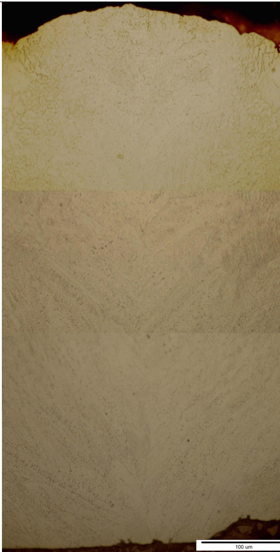
Slika 47. Mikrostruktura metala zavara nakon provlačenja
