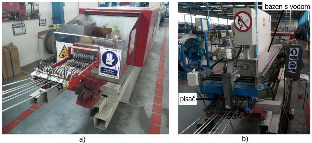
Slika 23. Ulaz cijevi u peć za toplinsku obradu (a) i izlaz cijevi iz peći za toplinsku obradu (b)
