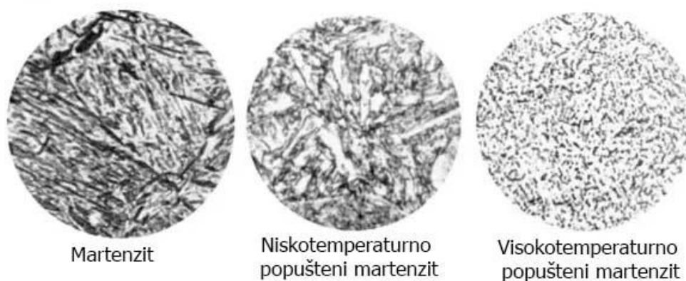
Slika 7. Martenzit pri različitim temperaturama popuštanja [7]
