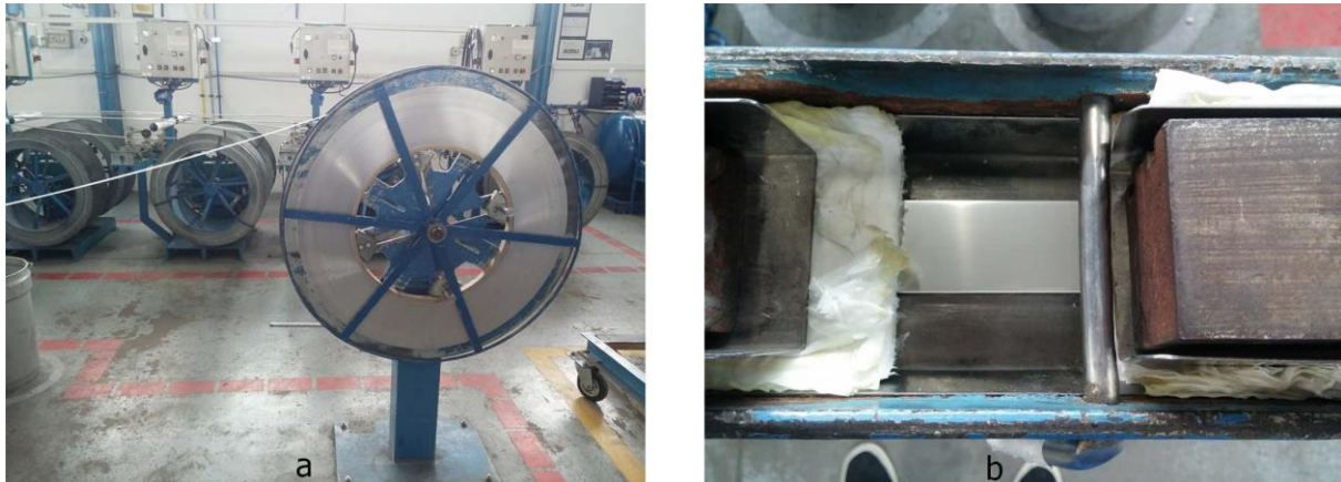
Slika 14. Odmatanje lima s koluta (a) i čišćenje lima acetonom (b)
