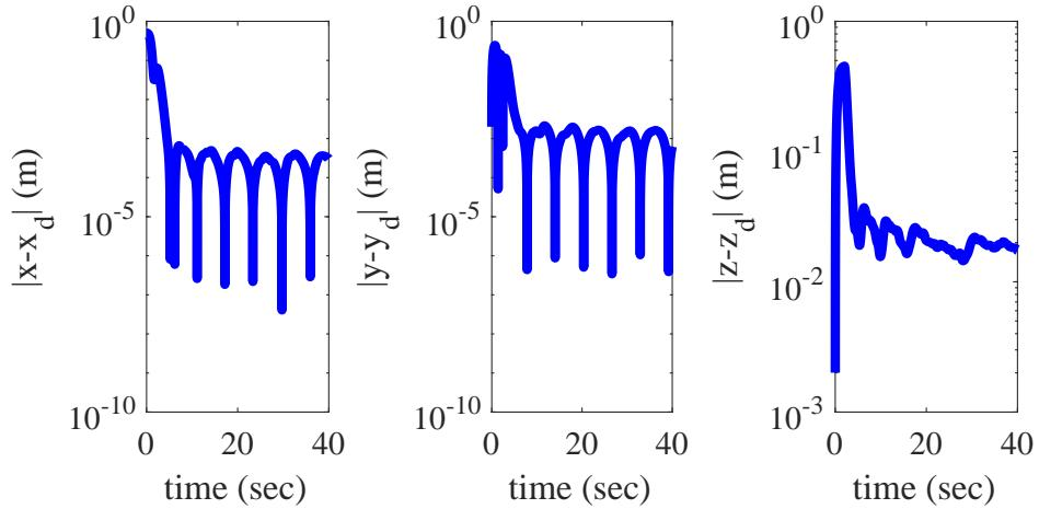
Slika 5.35: Pogreške slijedenja referentne trajektorije kod pojednostavljenog dinamičkog modela uz upravljanje s identificiranim parametrima
