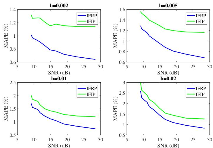
Slika 2.16: Usporedba performansi asimptotske metode pri filtriranju različitim položima(IFRP) i višestrukim polom(IFIP) pri početnoj brzini  $v_1 = 0$  i  $y_0 = 0$ .
