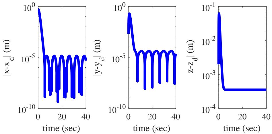
Slika 5.8: Pogreške slijedjenja referentne trajektorije kod pojednostavljenog dinamičkog modela
