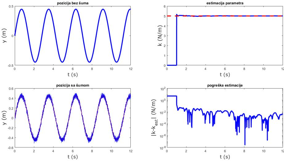
Slika 2.12: Neasimptotska identifikacija parametara primjenom metode frekvencijskog pomaka te filtriranje s višestrukim polom pri počenoj brzini  $v_0 = 0$ , a početnoj poziciji  $y_0 = 1$ .
