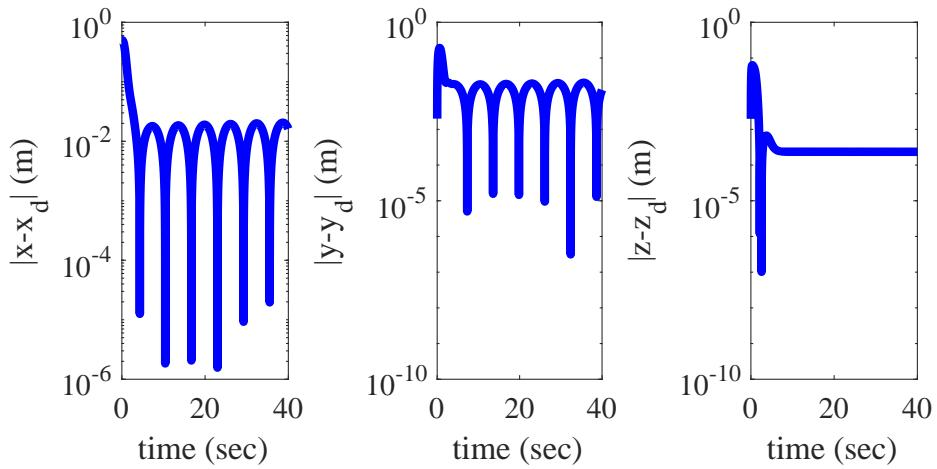
Slika 5.4: Pogreške slijedjenja referentne trajektorije kod punog dinamičkog modela
