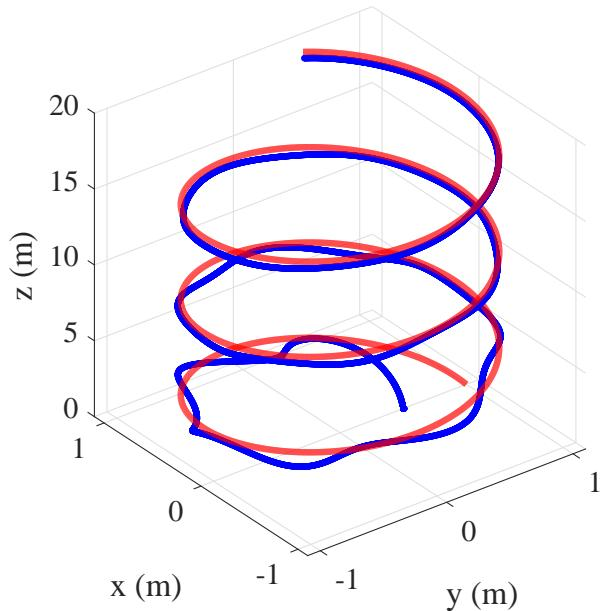
Slika 5.33: Neadaptivno slijedene referentne trajektorije za pojednostavljeni dinamički model uz upravljanje s identificiranim parametrima
