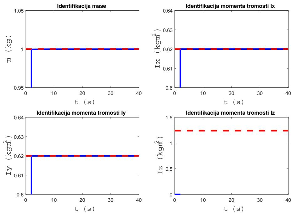
Slika 5.18: Identificirani parametri za najjednostavniji model s uvećanjem
