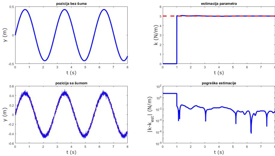
Slika 2.7: Neasimptotska identifikacija parametara primjenom metode algebarskog deriviranja pri počenoj brzini  $v_0 = 1$ , a početnoj poziciji  $y_0 = 0$ .
