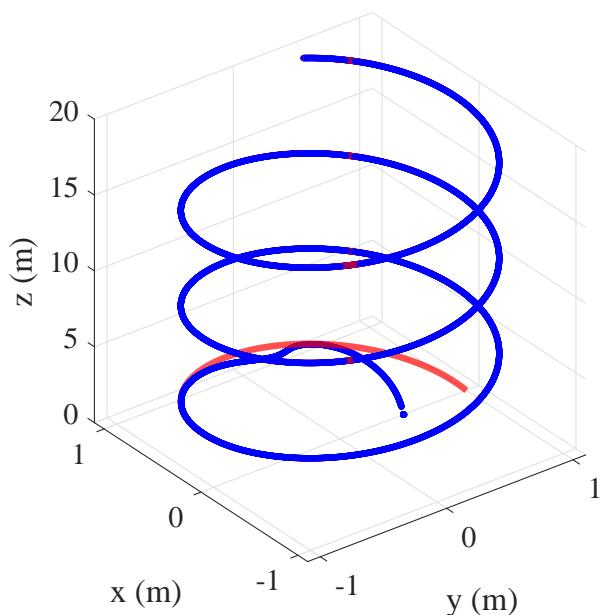
Slika 5.37: Slijedene referentne trajektorije za najjednostavniji dinamički model uz upravljanje s identificiranim parametrima
