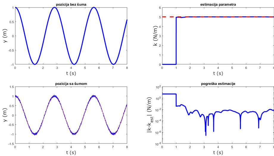
Slika 2.8: Neasimptotska identifikacija parametara primjenom metode algebarskog deriviranja pri počenoj brzini  $v_0 = 0$ , a početnoj poziciji  $y_0 = 1$ .
