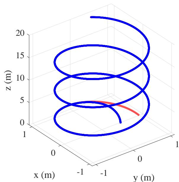
Slika 5.10: Slijedene referentne trajektorije za najjednostavniji dinamički model
