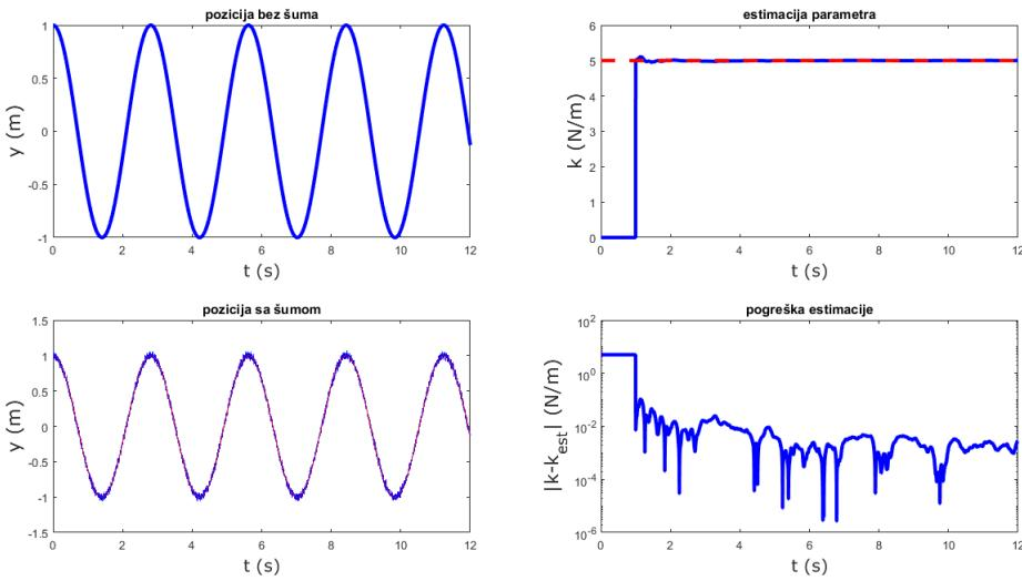
Slika 2.11: Neasimptotska identifikacija parametara primjenom metode frekvencijskog pomaka te filtriranje s višestrukim polom pri počenoj brzini  $v_0 = 1$ , a početnoj poziciji  $y_0 = 0$ .
