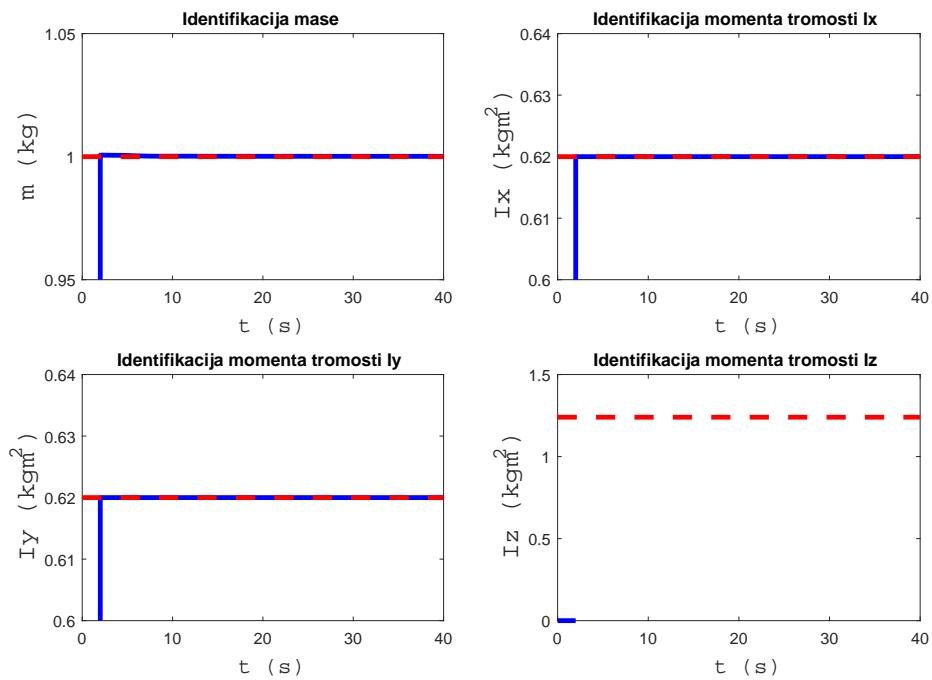
Slika 5.14: Identificirani parametri za pojednostavljeni model s uvećanjem
