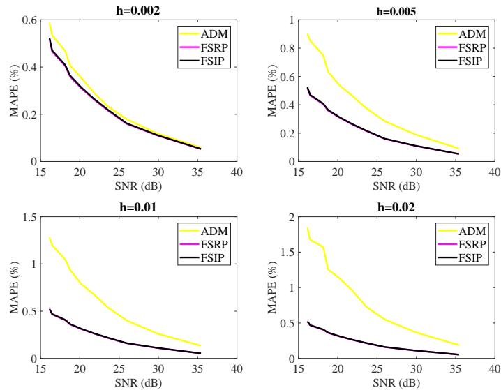
Slika 2.13: Usporedba performansi metode algebarskog deriviranja(ADM), i frequency-shifting pirstupa s različitim(FSRP) i višestrukim polovima(FSIP) pri početnoj brzini  $v_0 = 0$  i  $y_0 = 1$
