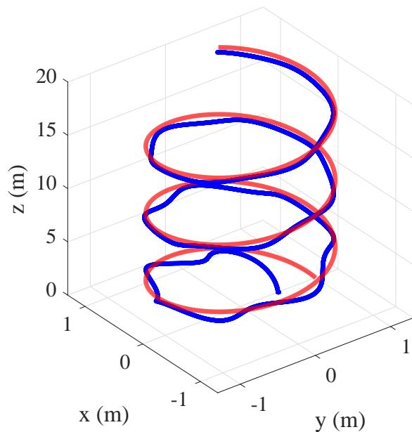
Slika 5.28: Neadaptivno slijedene referentne trajektorije za puni dinamički model uz upravljanje s identificiranim parametrima
