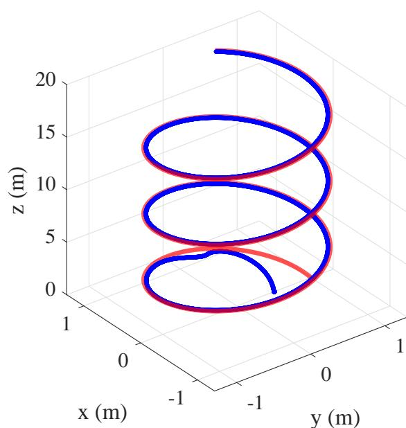
Slika 5.27: Slijedene referentne trajektorije za puni dinamički model uz upravljanje s identificiranim parametrima
