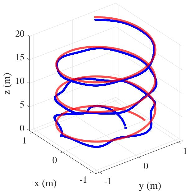
Slika 5.38: Neadaptivno slijedene referentne trajektorije za najjednostavniji dinamički model uz upravljanje s identificiranim parametrima
