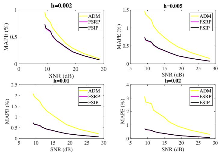
Slika 2.15: Usporedba performansi metode algebarskog deriviranja(ADM), i frequency-shifting pirstupa s različitim(FSRP) i višestrukim polovima(FSIP) pri početnoj brzini  $v_0 = 1$  i  $y_0 = 0$ .
