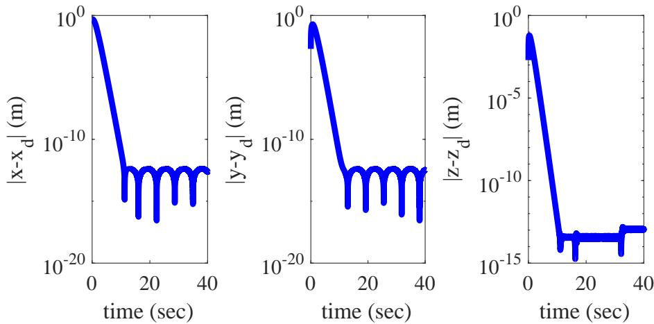
Slika 5.12: Pogreške slijedeњa referentne trajektorije kod najjednostavnijeg dinamičkog modela
