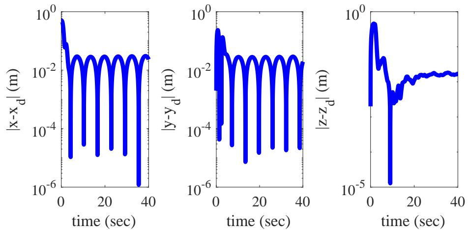
Slika 5.30: Pogreške slijedenja referentne trajektorije kod punog dinamičkog modela uz upravljanje s identificiranim parametrima
