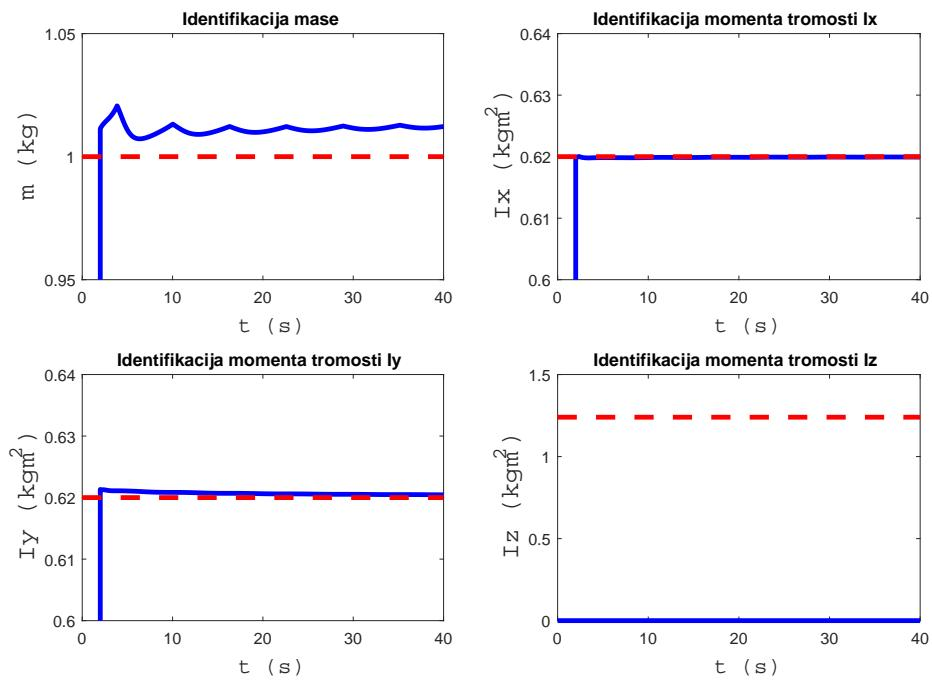
Slika 5.16: Identificirani parametri za puni model s uvećanjem
