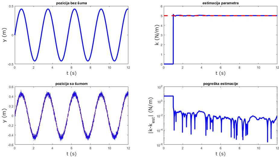
Slika 2.9: Neasimptotska identifikacija parametara primjenom metode frekvencijskog pomaka te filtriranje s različitim polovima pri počenoj brzini  $v_0 = 1$ , a početnoj poziciji  $y_0 = 0$ .
