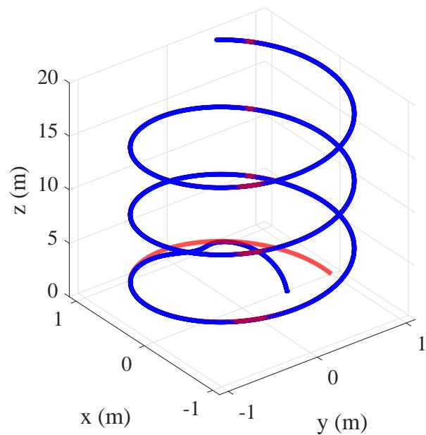
Slika 5.32: Slijedene referentne trajektorije za pojednostavljeni dinamički model uz upravljanje s identificiranim parametrima
