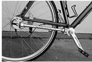
Slika 14. Bicikl sa vratilom umjesto lančanika
