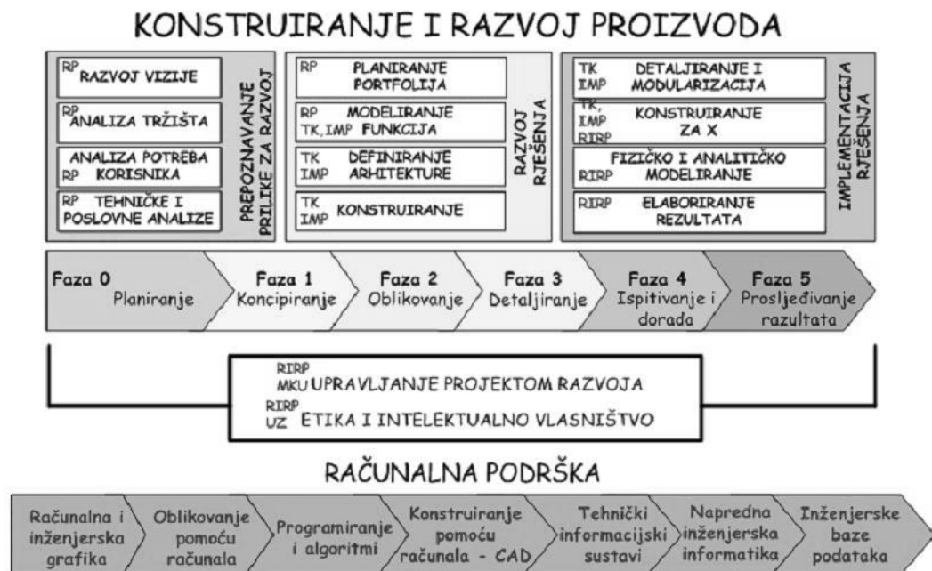
Slika 02. Poredak faza u konstruiranju i područja razvoja proizvoda sa kolegija Informacijski modeli proizvoda (Marjanović; Štorga, 2006/07.), FSB
