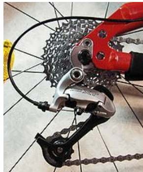
Slika 16. Kaset (set lančanika) na stražnjem kotaču
