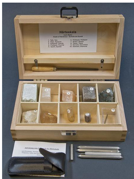
Slika 10. Oprema za ispitivanje tvrdoće po Mohs-u [7]
