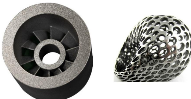
Slika 22. Kompleksni proizvodi izrađeni 3D DMLS-om [35,36,37]
