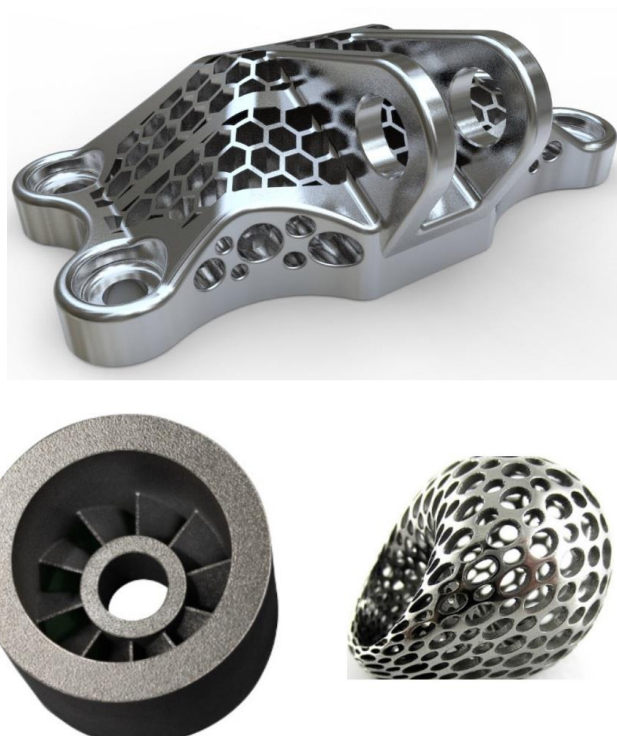
Slika 22. Kompleksni proizvodi izrađeni 3D DMLS-om [35,36,37]
