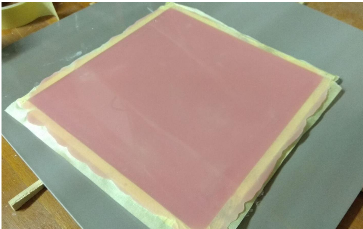
Slika 17. Ploča PMMA 3 izvan kalupa
