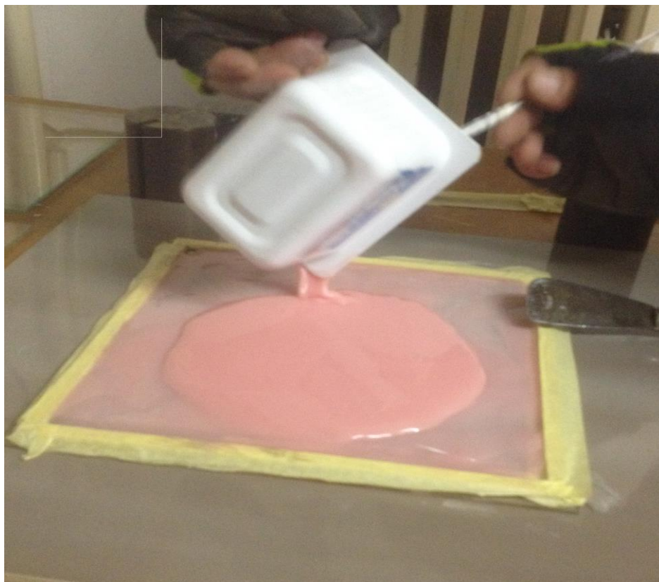
Slika 15. Ulijevanje ostatka materijala za ploču PMMA 2
