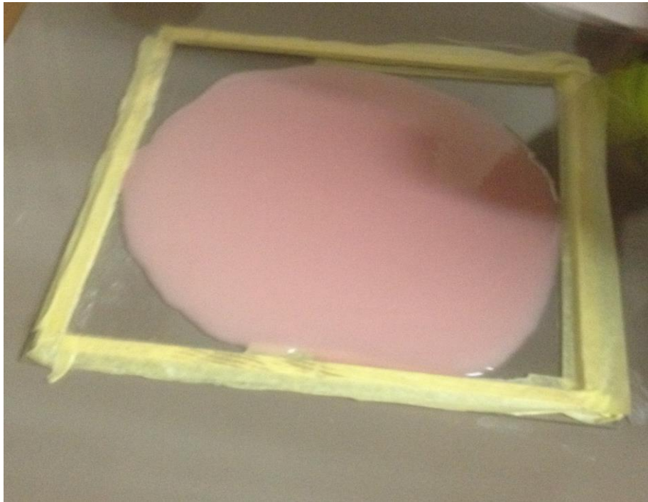
Slika 11. Ulijevanje PMMA u prvi kalup
