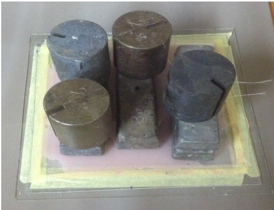
Slika 12. Ploča PMMA 1 s pokrovnim staklom i utezima
