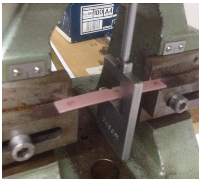
Slika 24. Pozicioniranje uzorka za Charpy-jev bat – drugi ciklus ispitivanja
