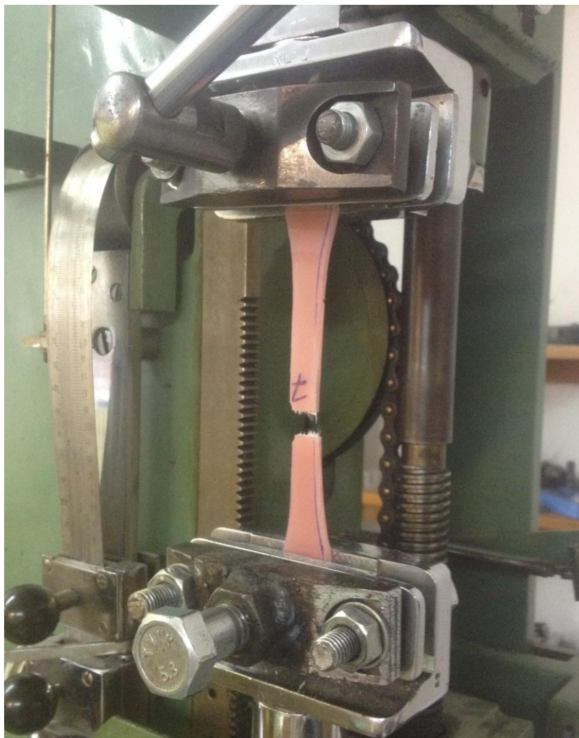
Slika 29. Lom epruvete u prvom ciklusu ispitivanja statičkog vlačnog pokusa
