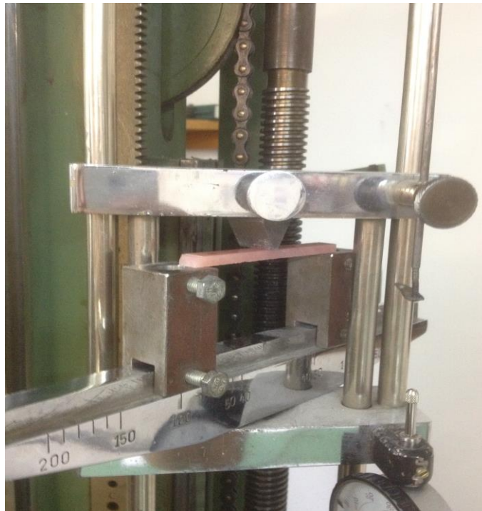
Slika 26. Pozicioniranje epruvete za ispitivanje savijanja u tri točke
