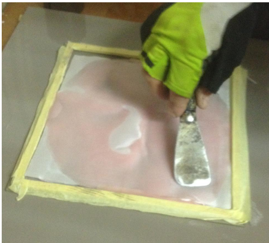
Slika 14. Zaglađivanje staklenih vlakana ploče PMMA 2
