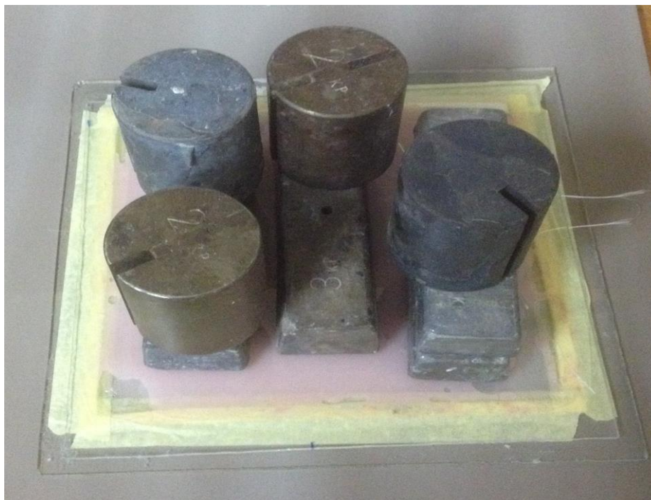
Slika 12. Ploča PMMA 1 s pokrovnim staklom i utezima
