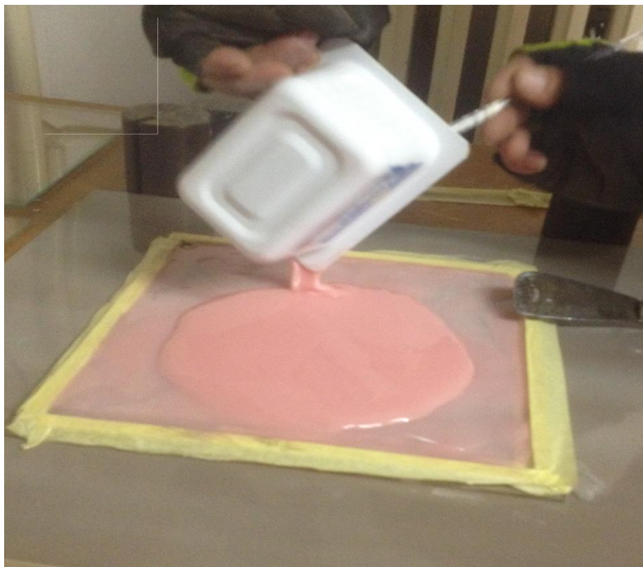
Slika 15. Ulijevanje ostatka materijala za ploču PMMA 2
