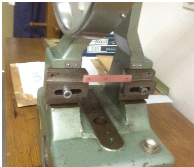
Slika 23. Pozicioniranje uzorka za Charpy-jev bat – prvi ciklus ispitivanja
