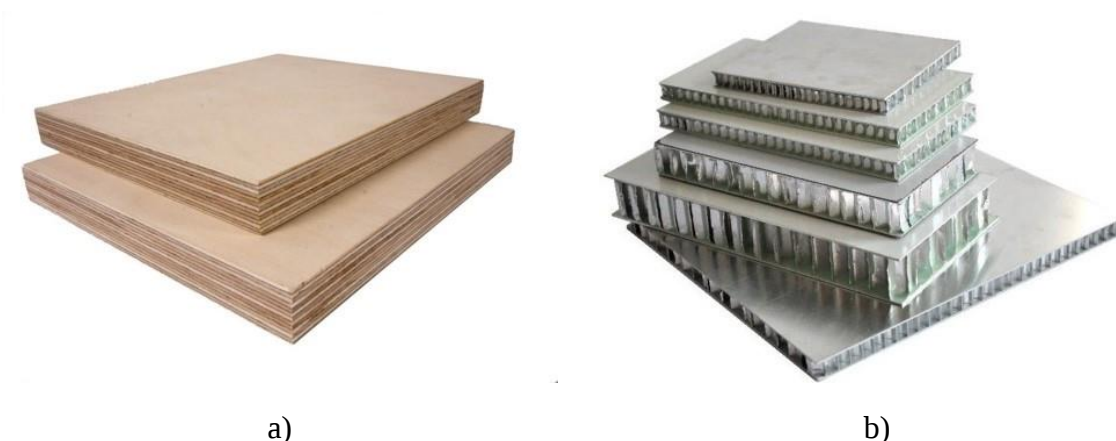
Slika 2. Strukturalni kompoziti: a) višeslojni kompozit – šperploča breze [9]; b) aluminijska sandwich struktura s jezgrom u obliku pčelinjih saća [10]
