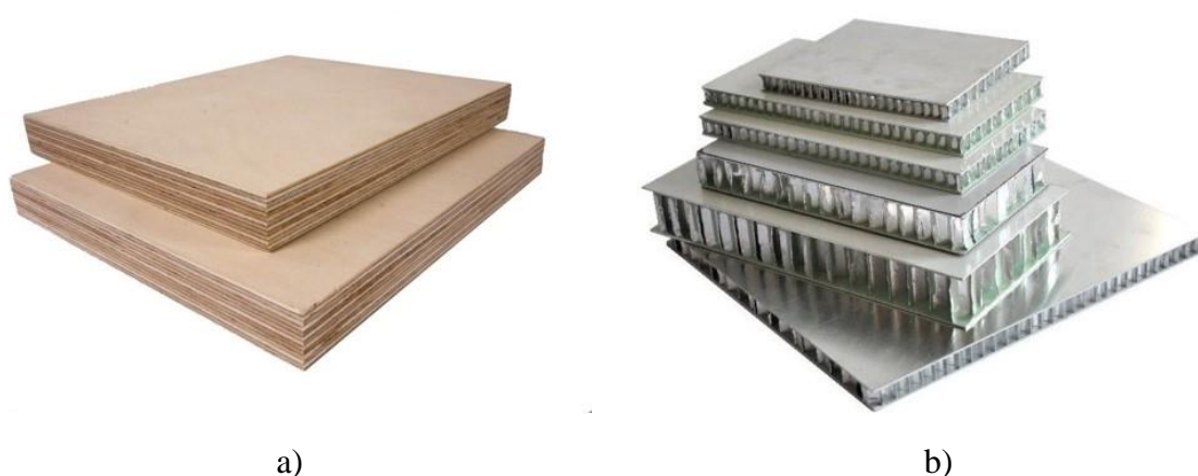
Slika 2. Strukturalni kompoziti: a) višeslojni kompozit – šperploča breze [9]; b) aluminijska sandwich struktura s jezgrom u obliku pčelinjih saća [10]
