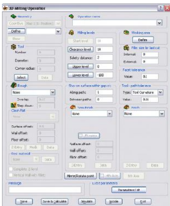
Slika 76. Prozor operacije 3D glodanja sa parametrima
