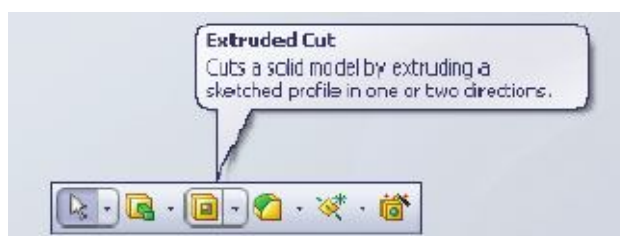
Slika 62. Funkcija Extruded Cut
