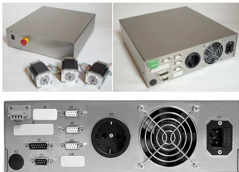
Slika 95. Upravljačka jedinica CNCMAX 4/24 [22]
