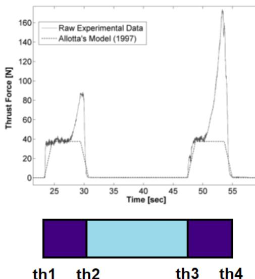
Slika 40. Nehomogeni materijal – prikaz parametara algoritma[12]
