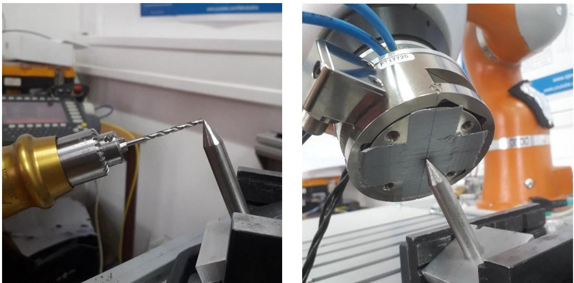
**Slika 43. Kalibracija TCP-a svrdla i TCP-a senzora sile**
