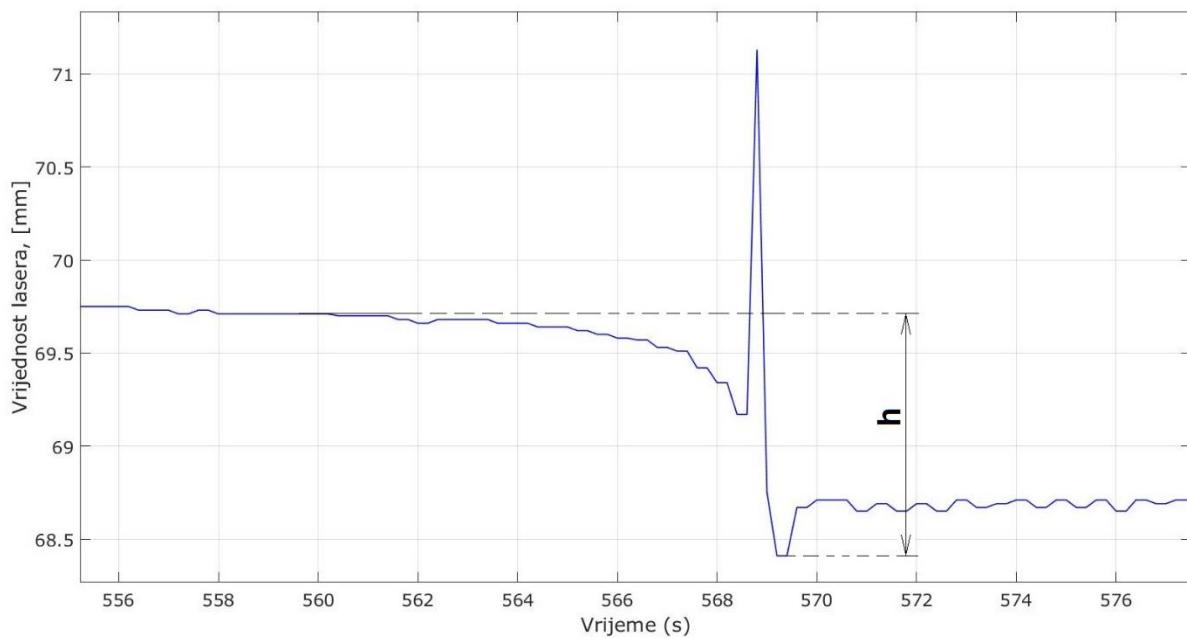
Slika 57. Udaljenost očitana sa laserskoga mjerača udaljenosti
