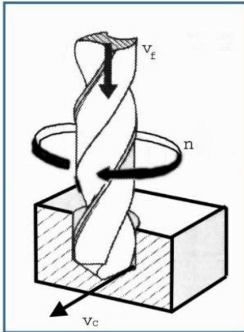
Slika 8. Shematski prikaz bušenja vijčanim svrdlom [4]
