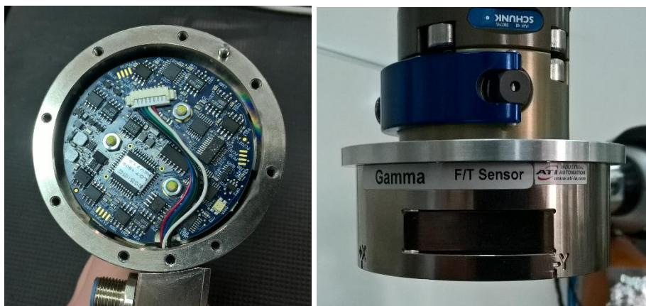
Slika 24. Gamma pretvornik (SI-65-5)
