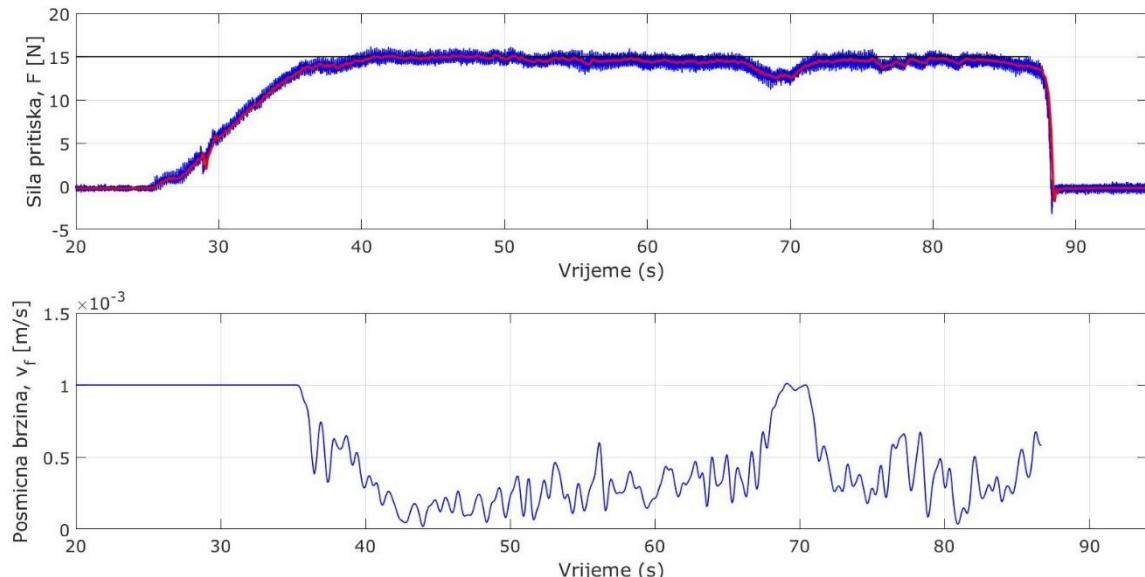
**Slika 55. Sila pritiska i posmična brzina bušenja; kost;
