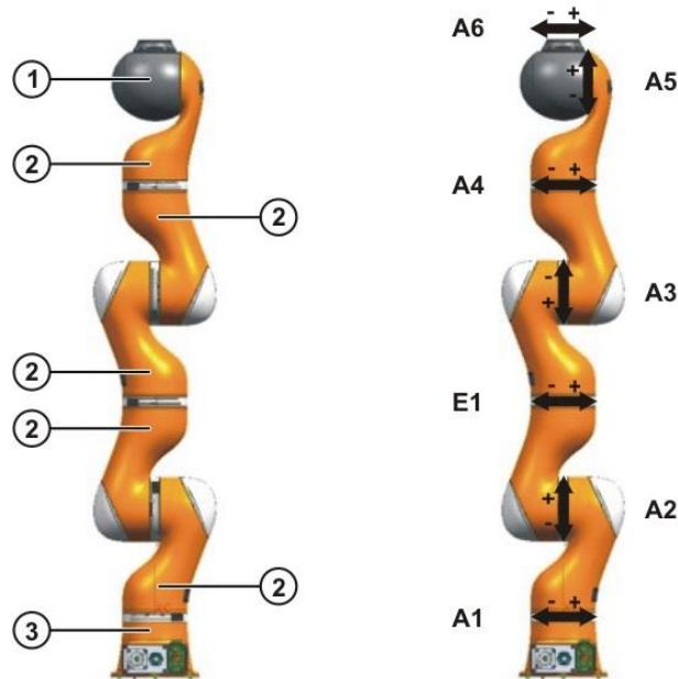
**Slika 32. Kuka LWR 4+ – elementi i upravljačke rotacijske osi [9]**
