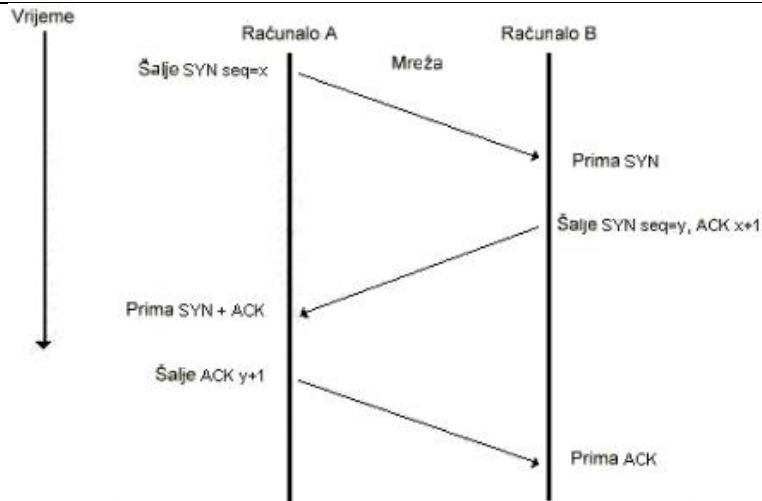
Slika 21. *Three-way handshake – uspostava veze korištenjem TCP protokola [7]*
