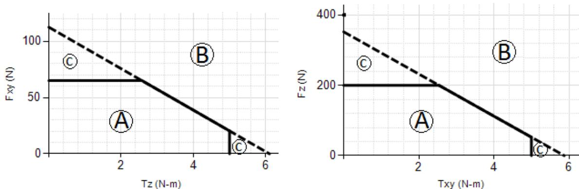
**Slika 25. Mjerni opsezi Gamma pretvornika (SI-65-5) [8]**
