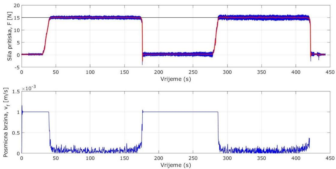
**Slika 51.** Sila pritiska i posmična brzina bušenja; lim – eps - lim;
