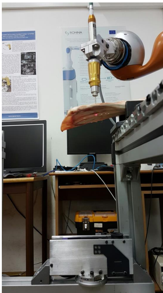
Slika 56. Kvantifikacija duljine hoda svrdla prilikom proboja
