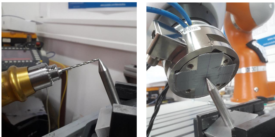
Slika 43. Kalibracija TCP-a svrdla i TCP-a senzora sile
