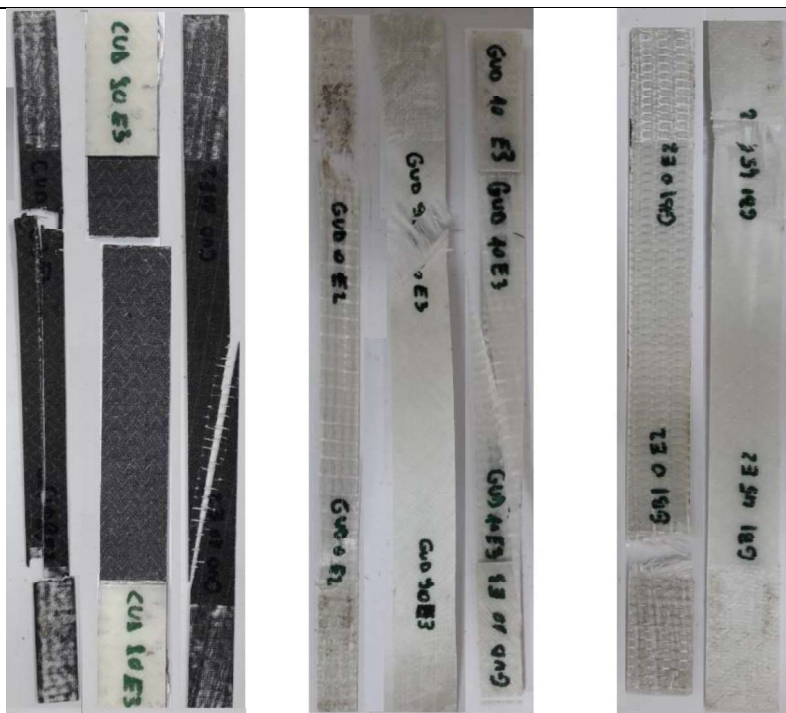
Slika 4.8 Načini popuštanja ispitanih epruveta, s lijeva na desno: UD CFRP (0°, 90°, 10°), UD GFRP 0°, BIAX GFRP 45°/-45°, UD GFRP 10°, UD GFRP 90°, BIAX GFRP 0°/90°
