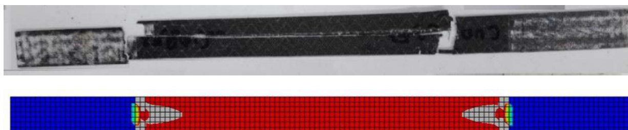
Slika 7.6 Mehanizmi popuštanja u eksperimentu (gore) i numeričkoj simulaciji (dolje)
