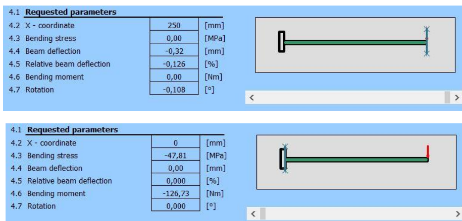
Slika 34. MITCalc ( progib i naprezanje od savijanja)
