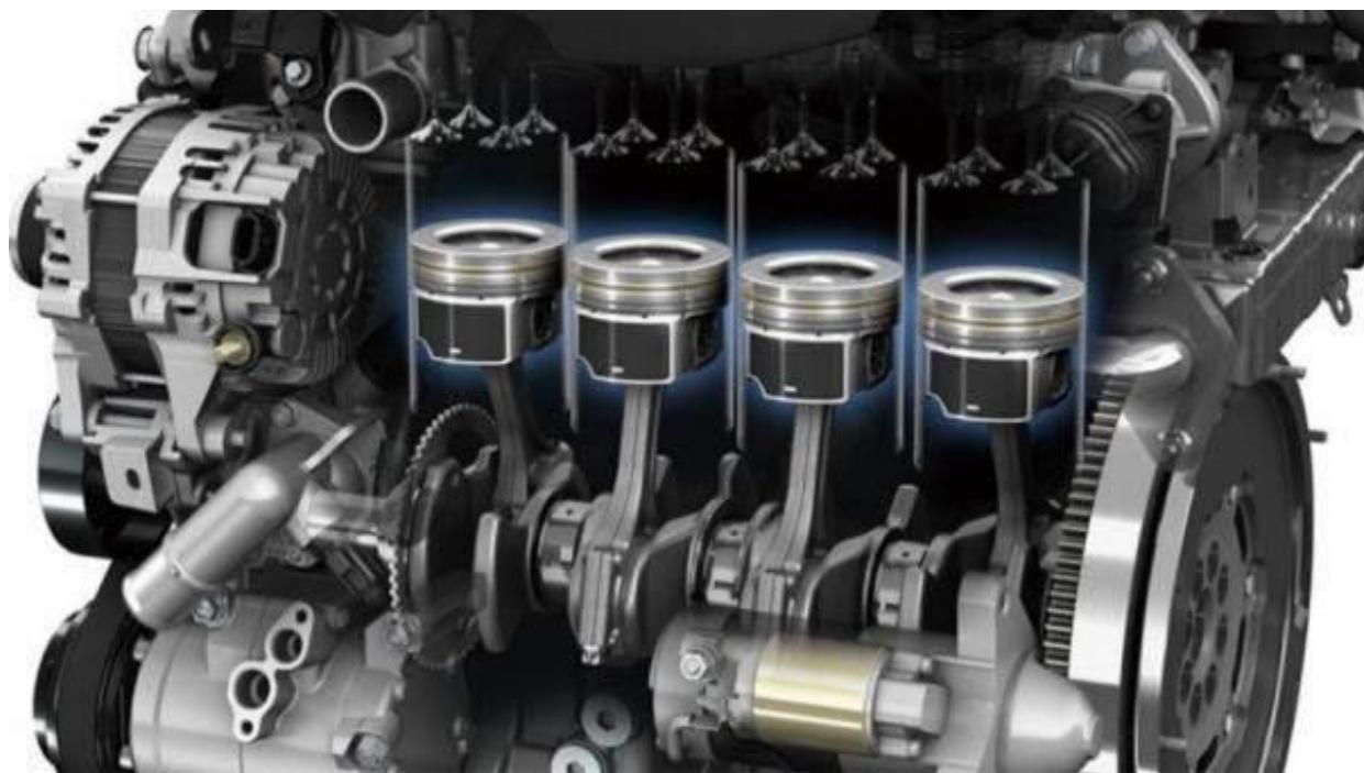
Slika 3. Koljenasto vratilo u motoru
