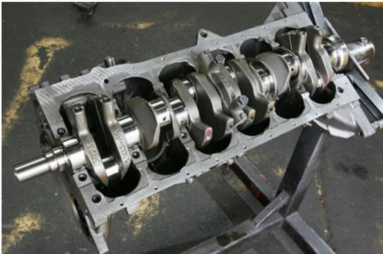
Slika 4. Uležištenje koljenastog vratila u kućište motora
