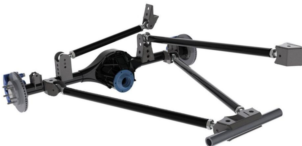
Slika 6. Zavisni ovjes s 3 vodilice i Panhard motkom [8]
