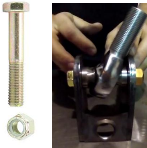
Slika 13. Vijak i matica (lijevo), spoj zgloba na nosač (desno) [16]
