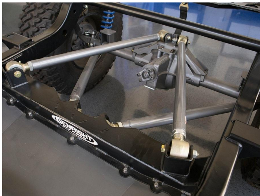
Slika 5. Zavisni ovjes s 4 vodilice [7]
