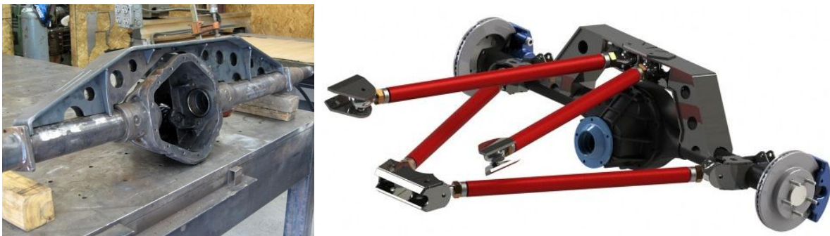
Slika 20. Kućište osovine s ojačanjem [25, 26]
