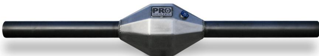
Slika 25. Spidertrax kućište krute osovine [31]
