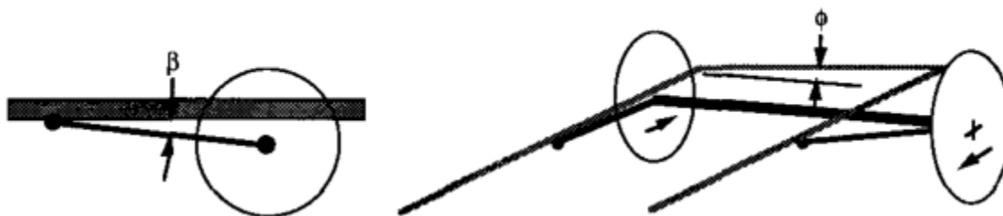
Slika 57. Roll steer stražnje krute osovine [49]
