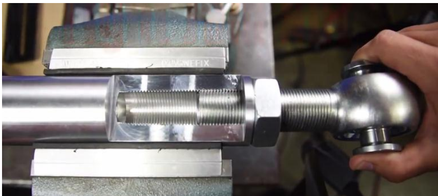
Slika 10. Spoj cijevi i zgloba [13]
