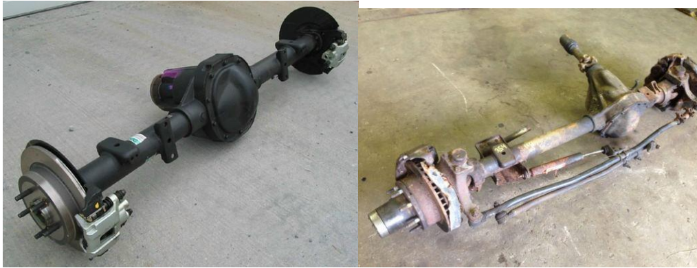
Slika 15. Stražnja [17] i prednja [18] pogonska kruta osovina
