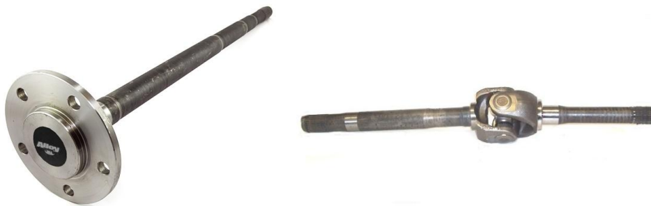
Slika 16. Vratilo stražnje [19] i prednje [20] krute osovine
