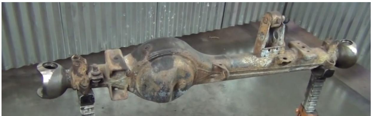
Slika 19. Kućište krute osovine [24]
