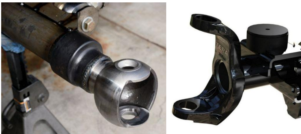
Slika 21. Krajevi kućišta osovine [27, 28]
