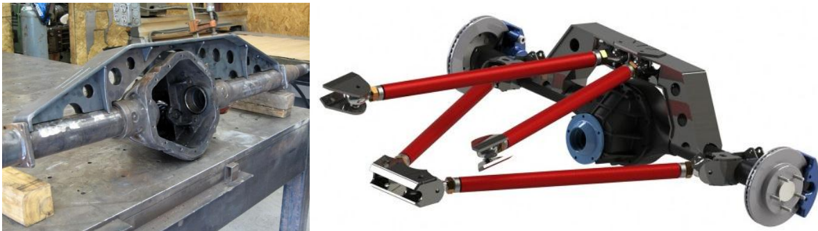
Slika 20. Kućište osovine s ojačanjem [25, 26]
