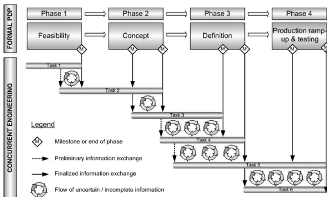
Slika 1. Shematski prikaz razvoja procesa s kontrolnim točkama [2]
