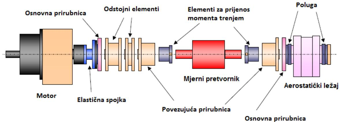
Slika 8. Shema za umjeravanje apsolutnom metodom (2) [6]
