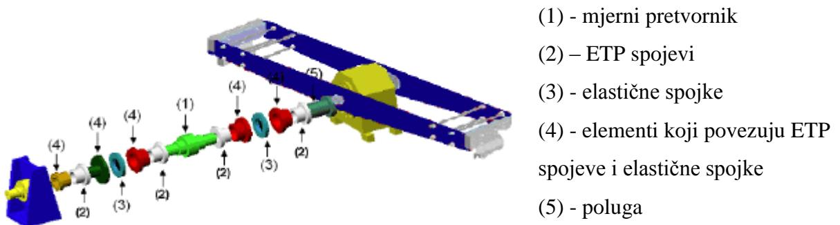
Slika 23. Uredaj za umjeravanje mjernih pretvornika do 1000 N·m - shema (CENAM) [9]
