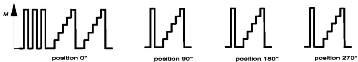
Slika 60. Primjer preopterećenja i redoslijeda umjeravanja za vratila/utore kvadratnog presjeka s minimalno 5 koraka umjeravanja, samo za rastući moment; mjerna nesigurnost uređaja za umjeravanje  $0,1 \leq U < 1\%$  [31]
