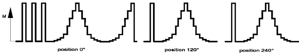
Slika 58. Primjer preopterećenja i redoslijeda umjeravanja s minimalno 8 koraka umjeravanja i mjernu nesigurnost uređaja za umjeravanje  $U < 0,1\%$  [31]
