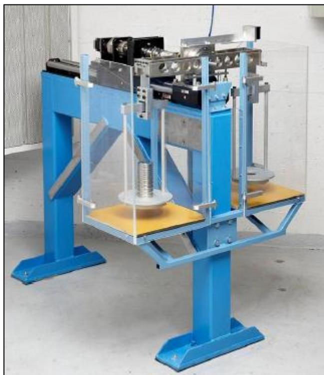
Slika 20. Uredaj za umjeravanje mjernih pretvornika do  $50 \text{ N}\cdot\text{m}$  (MIKES RAUTE) [16]
