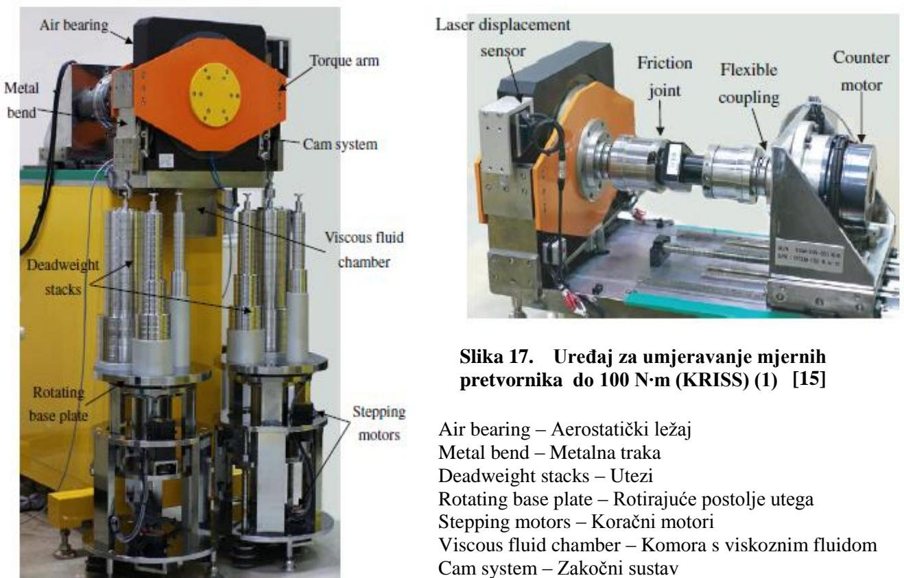
**Slika 18. Uredaj za umjeravanje mjernih pretvornika do  $100 \text{ N}\cdot\text{m}$  (KRISS) (2) [15]**
