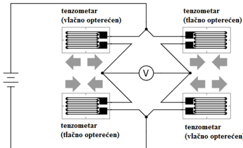
Slika 5. Primjer Wheatstoneovog mosta na torzijski opterećenom vratilu [1]
