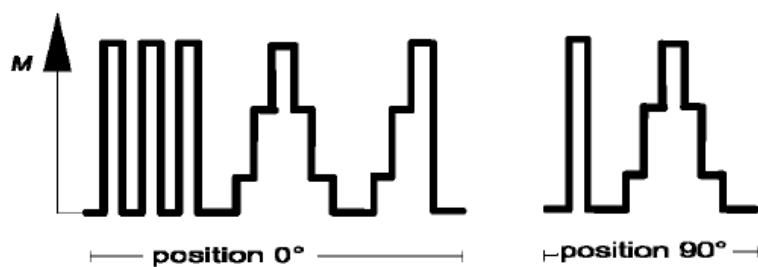
Slika 61. Primjer preopterećenja i redoslijeda umjeravanja za vratila/utore kvadratnog presjeka s minimalno 3 koraka umjeravanja i mjernu nesigurnost uređaja za umjeravanje  $U \geq 1\%$  [31]
