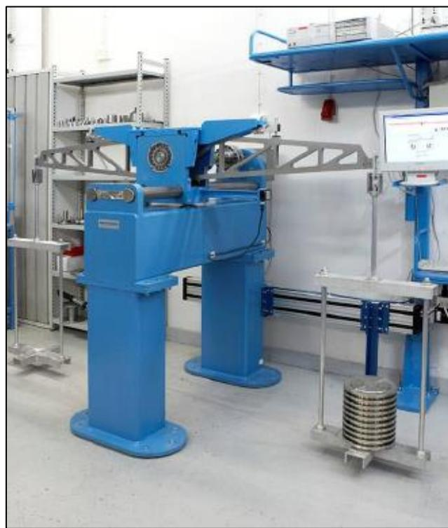
Slika 19. Uredaj za umjeravanje mjernih pretvornika do 2000 N·m (MIKES RAUTE) [16]
