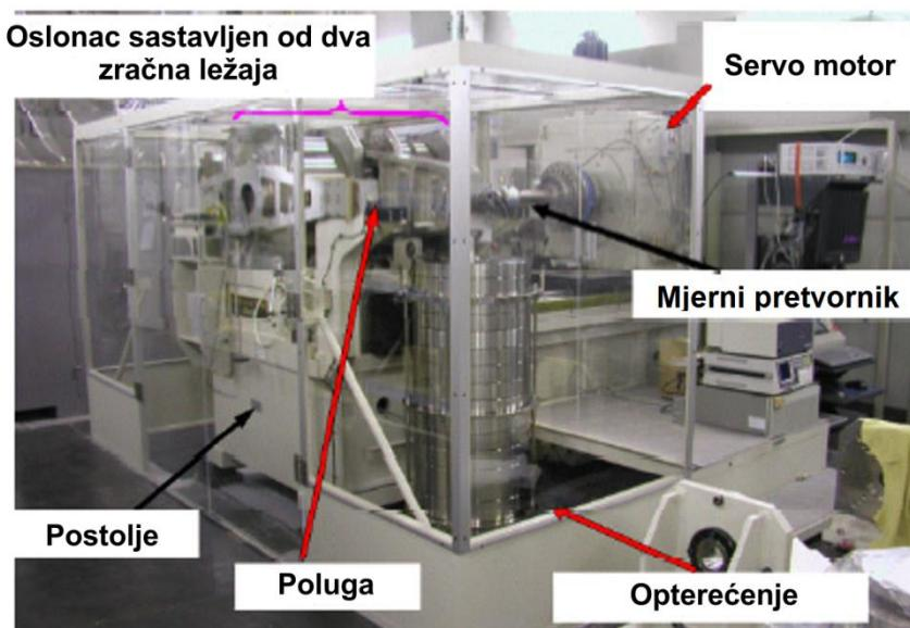
Slika 16. Uredaj za umjeravanje mjernih pretvornika do 20000 N·m (NMIJ) [14]
