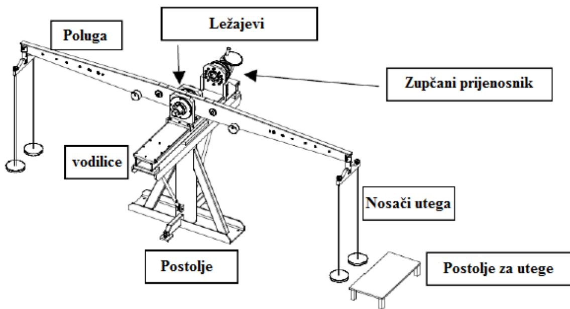
Slika 24. Uredaj za umjeravanje mjernih pretvornika od 500 N·m - 5000 N·m (NORBAR) [18]
