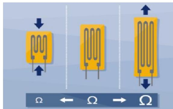
Slika 4. Promjena otpora uslijed produljenja tenzometra
