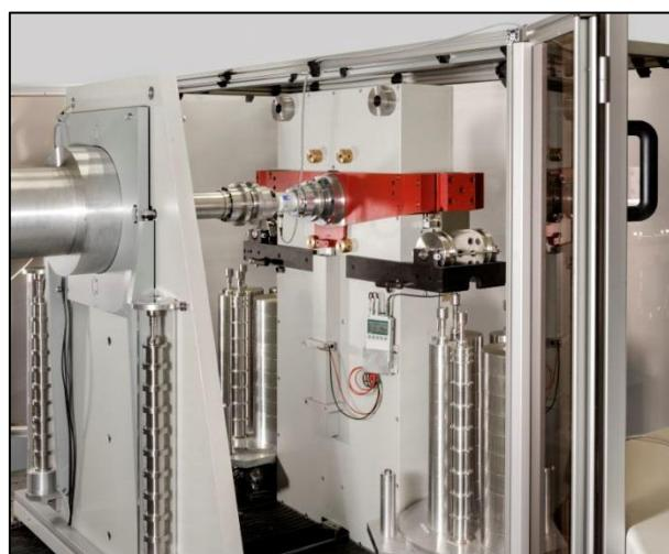
**Slika 14. Uredaj za umjeravanje mjernih pretvornika do 1000 N·m (PTB) [13]**
