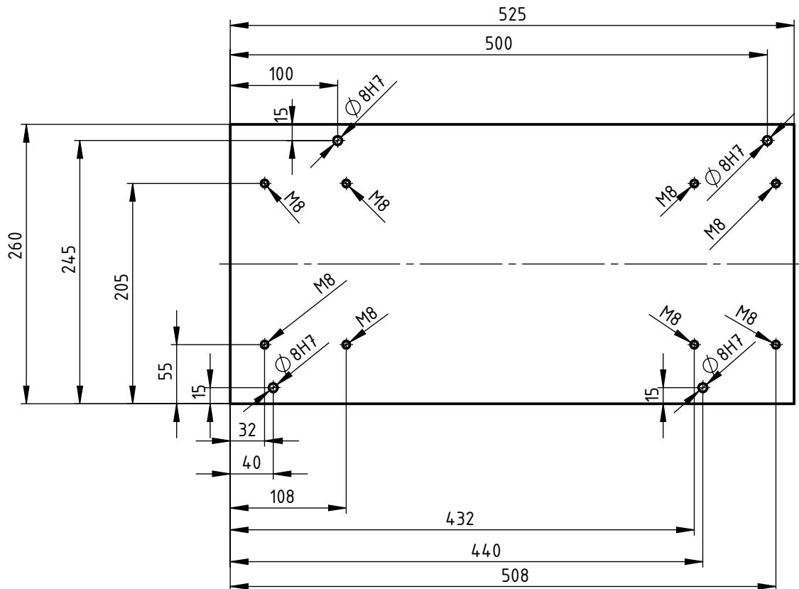
Debljina ploče  $t=20\text{mm}$ .
