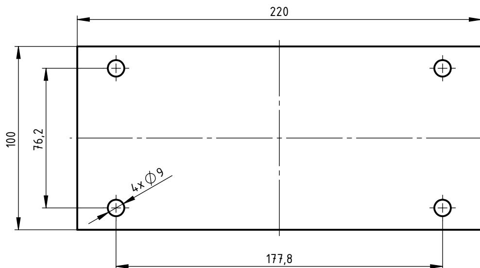
Provrite  $\varnothing 9$  bušiti nakon zavarivanja sa stupom ležaja (vidi sklopni crtež).
