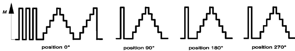
Slika 59. Primjer preopterećenja i redoslijeda umjeravanja za vratila/utore kvadratnog presjeka s minimalno 5 koraka umjeravanja i mjernu nesigurnost uređaja za umjeravanje  $0,1 \leq U < 1\%$  [31]
