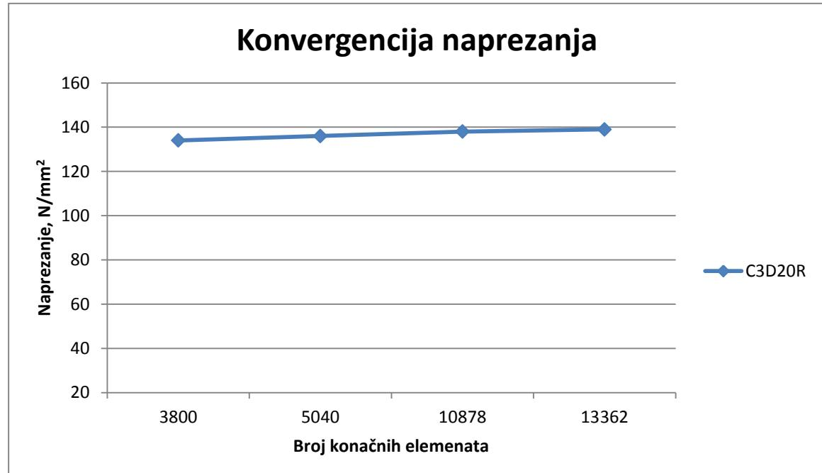
Slika 56. Konvergencija naprezanja s povećanem brojem konačnih elemenata
