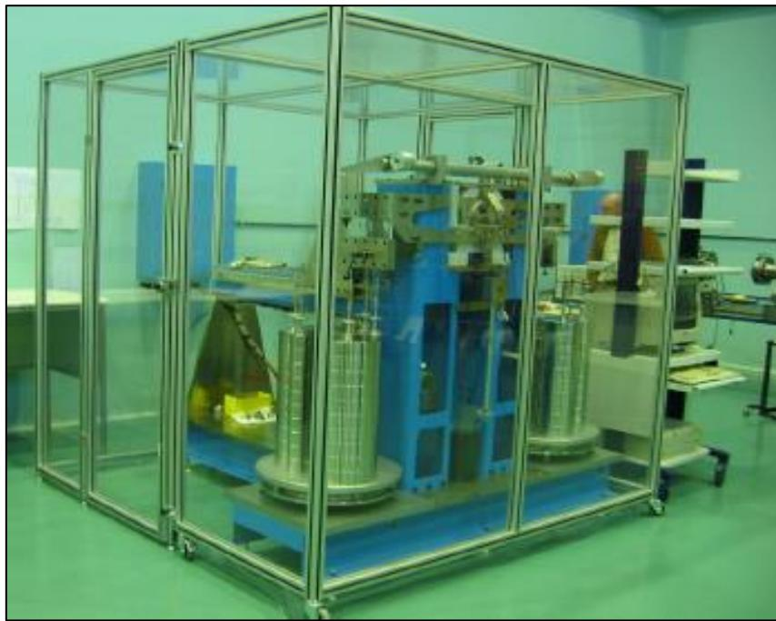
Slika 21. Uredaj za umjeravanje mjernih pretvornika do 1000 N·m (CEM) [17]
