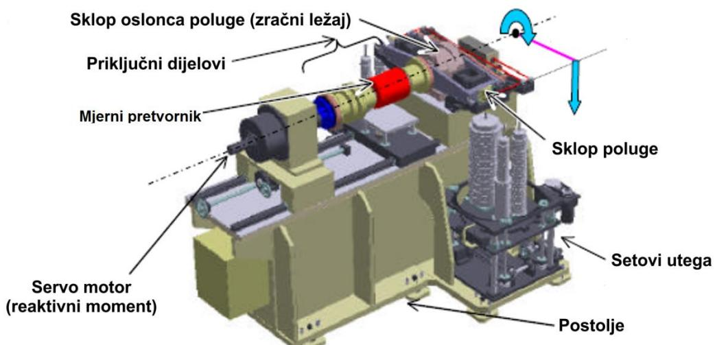
Slika 15. Uredaj za umjeravanje mjernih pretvornika do  $1000 \text{ N} \cdot \text{m}$  (NRLM) [6]
