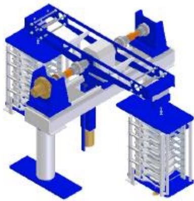
Slika 22. Uredaj za umjeravanje mjernih pretvornika do 1000 N·m (CENAM) [9]
