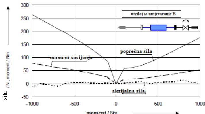
Slika 36. Rezultati mjerjenja momenta savijanja i poprečnih sila u slučaju a) i b) [10]
