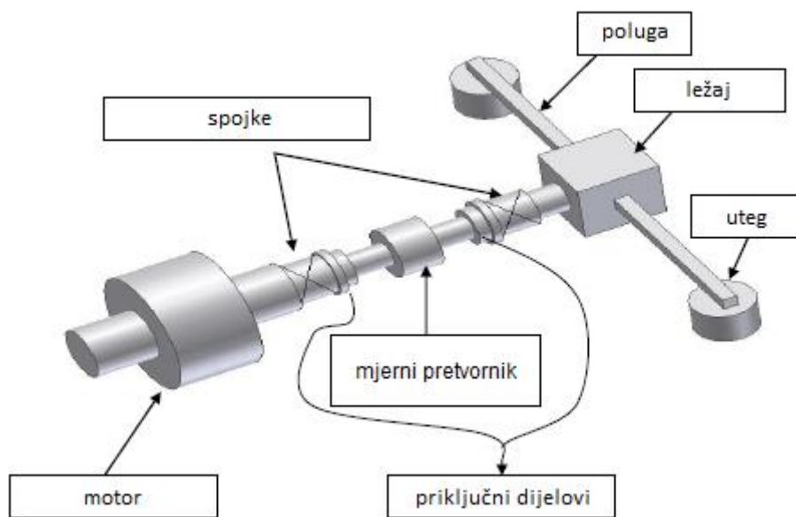
**Slika 7. Shema uređaja za umjeravanje apsolutnom metodom (1) [5]**
