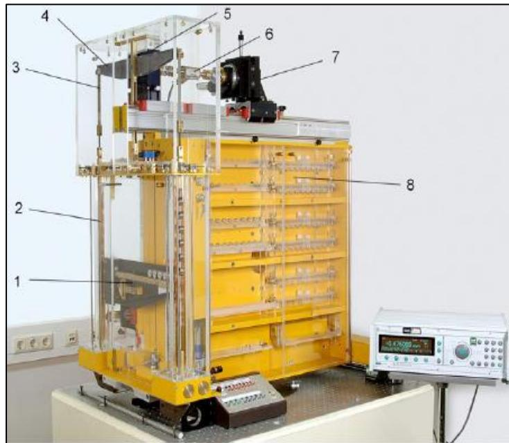
**Slika 13. Uredaj za umjeravanje mjernih pretvornika do 1 N·m (PTB) [12]**
