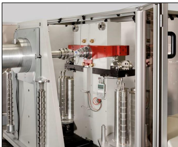
Slika 14. Uređaj za umjeravanje mjernih pretvornika do 1000 N·m (PTB) [13]
